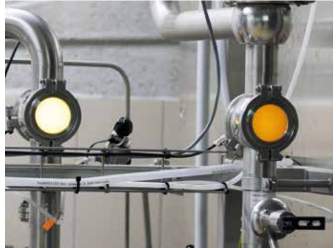
Das Bier vor der Klärung (rechts) und nach der Klärung (links) – die Trübstoffe wurden mit dem Flottweg Separator aus dem Bier entfernt.
