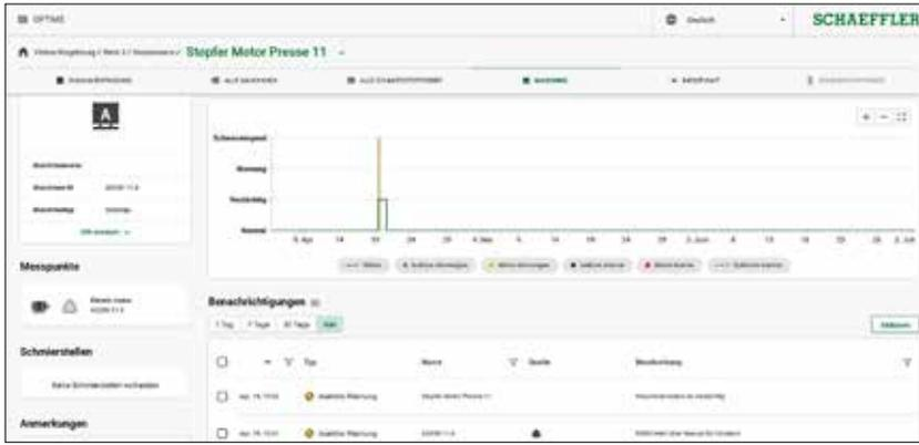
Die App Optime Mobile alarmierte ein Signal am Antrieb einer Zuführschnecke. Das Bild zeigt das alarmierte Ereignis. Der Status wird als normal, verdächtig, Warnung und schwerwiegend angezeigt.
