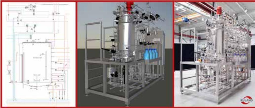
Design der Prozessanlage: Komplexe Anlagen und Fermenter werden zunächst im Blockbild, dann im R&I-Diagramm geplant. Im nächsten Schritt wird die Anlage für eine schnelle und detailgenaue Fertigung im 3D dargestellt.
