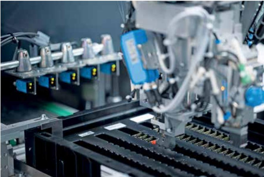
Smart Tasks im Einsatz: Die Sensoren erkennen die individuelle Belegung eines Werkstückträgers und teilen der Robotersteuerung direkt mit, auf welchen Steckplätzen sich Werkstücke befinden.
