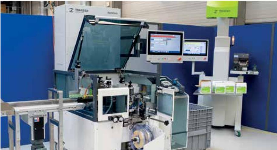
Die ItemUnit-Tamper Evident von Traxeed kennzeichnet mehr als fünf Produkte pro Sekunde. Darin arbeitet ein kompakter Tamper-Evident-Etikettierer von Bluhm Systeme.
