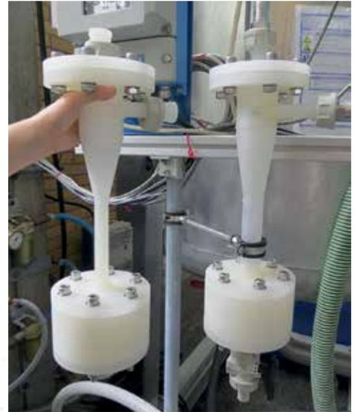
einer deutlich besseren Trennleistung des WTZA-XE-Wolftechnik-Zentrifugalabscheiders im Vergleich zum Standardgerät WTZA, liegt der Differenzdruck des neu entwickelten Zyklons im Vergleich nur gering über dem des Standardgeräts.
