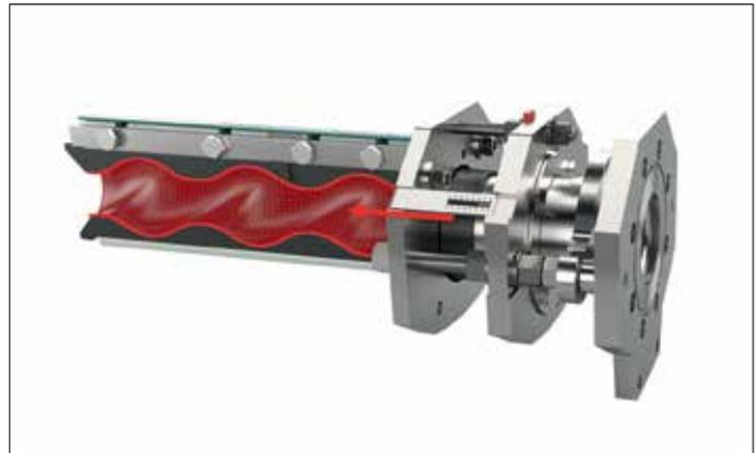
Die xLC<sup>®</sup> Einheit presst eine axial gelagerte Hülse in Richtung des Elastomerkerns und schiebt ihn im Gehäuse zusammen. Dies sorgt für eine Erhöhung der Vorspannung und Wiederherstellung der Dichtlinie.
