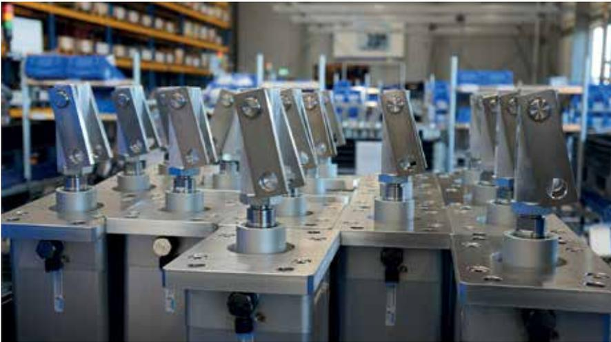
Für den Indien-Auftrag wurden Zylinder nach ISO 15552 mit verschiedenen Durchmesser von 100 bis 160 Millimetern verwendet.
