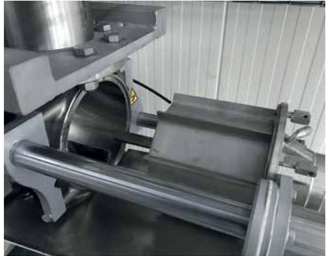
Zellenradschleusen, hier mit ausgezogenem Rotor, werden in der Schüttgutindustrie zum Austragen und Dosieren von staub-, pulver- oder granulatförmigen Feststoffen eingesetzt.
