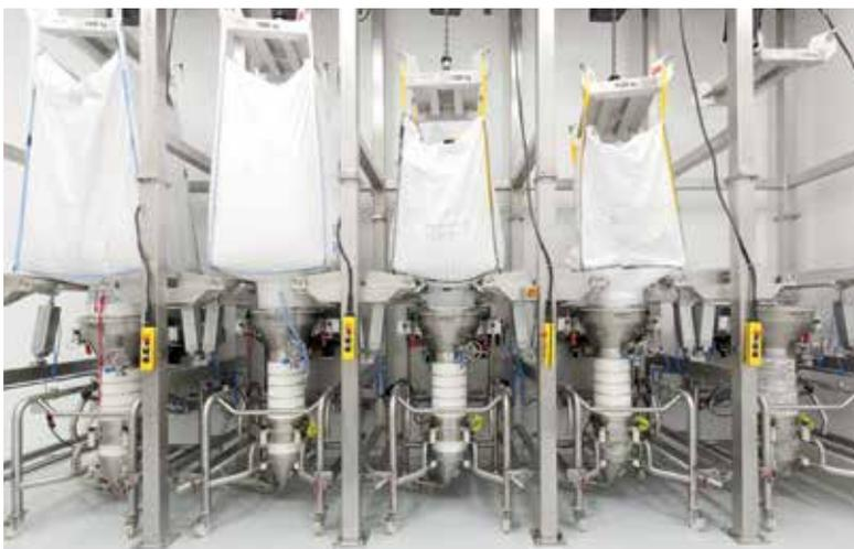
Das 5-fache Kragarmportal in Spezialbauweise besteht aus drei kompletten Portaleinheiten mit zwei Querverstrebungen.
