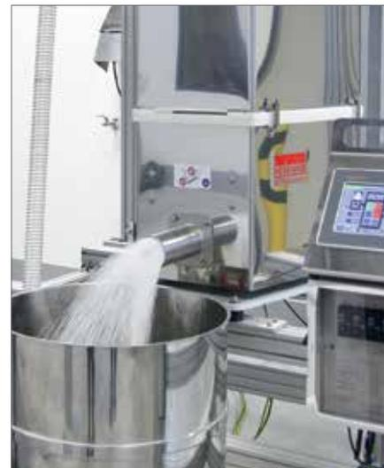
Wenn die Filterleistung nicht ausreicht, drückt in großen Rohren die Luft mehr Pulver aus dem Schneckenrohr (r.), als eigentlich dosiert werden sollte. JetFilter können für einen normalen Produktfluss (l.) sorgen.
