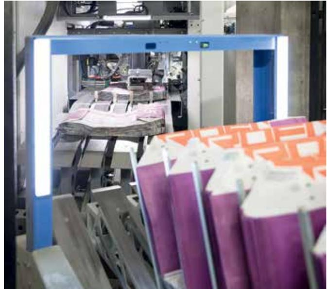
Die Fillpac-Anlage ist mit einem Sackbündelmagazin ausgerüstet.
