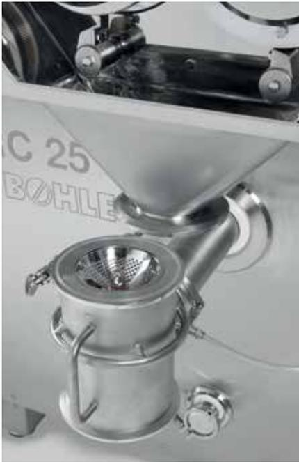
Eine konische BTS-Turbo-Siebmühle sorgt für eine besonders schonende Zerkleinerung der Schülpen.
