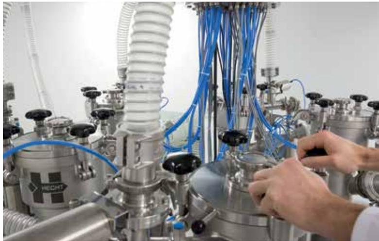
Über ein speziell konstruiertes Rohrleitungssystem werden die Rohstoffe mit Hilfe von Vakuumpförderern zu den angrenzenden Räumlichkeiten befördert.
