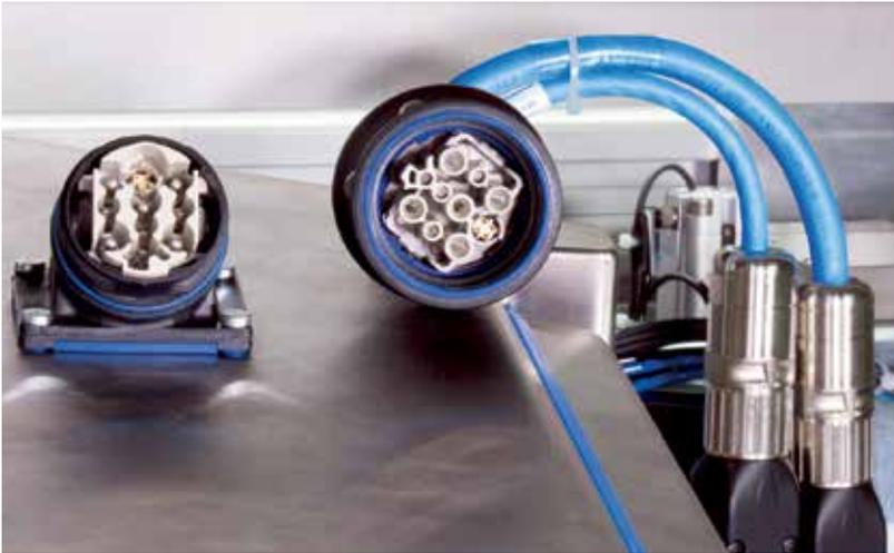
**Geschirmte Datenübertragung im F+B-Einsatz: Mit den Steckverbindern verkürzen sich Werkzeugwechsel und Service-Einsätze.**
