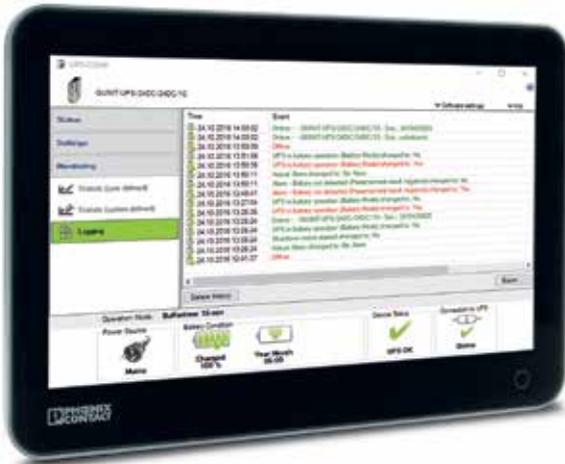
Batteriemanagement: Das USV-System mit IQ-Technologie kommuniziert Betriebs- und Batteriezustände, wie verbleibende Pufferzeiten und ausstehende Lebensdauer der Batterie.
