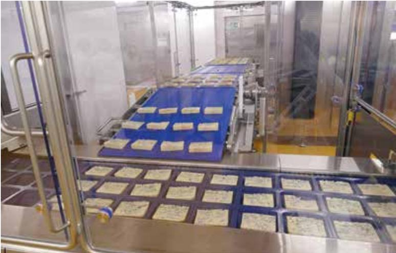
Die im vorangegangenen Prozess geschnittenen Käseportionen werden in die Unterschalen der Verpackung eingelegt und danach mit einer Folie von oben versiegelt.
