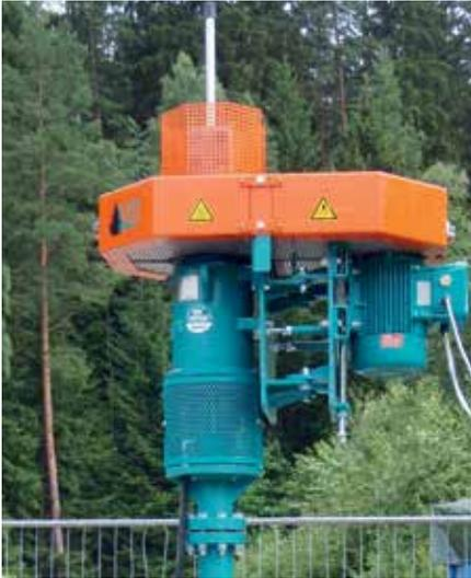
Die Drehzahl der Pumpe lag bei 100 bis 200 Umdrehungen pro Minute, sodass der natürliche Schmiereffekt, den die Sole bei höheren Fließgeschwindigkeiten ausübt, genutzt und ein Elastorabrieb am Stator vermieden werden konnte.
