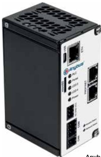
Anybus Edge-Gateway verbindet unterschiedliche industrielle Netzwerke mit der Cloud.
