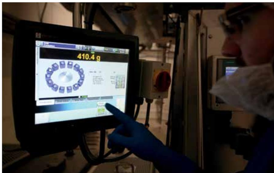
Die Bedienung der Mehrkopfwage erfolgt unkompliziert am Touchscreen.
