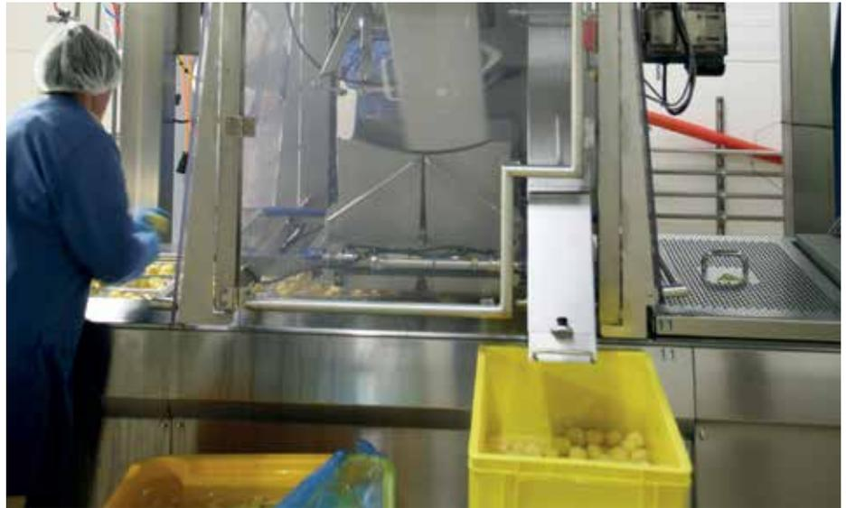
Eine Verteileinheit füllt die präzise dosierten Produktportionen für Zielgewichte zwischen 400 und 5.000 g direkt in die Tiefziehpackungen.
