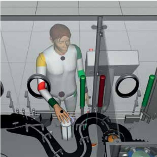
Mit Hilfe von virtuellem Bedienpersonal wird die Erreichbarkeit verschiedener Bedienelemente überprüft. Die Farben an den Gelenken zeigen an, wie belastend die jeweilige Haltung ist, wenn sie längere Zeit eingenommen werden muss.
