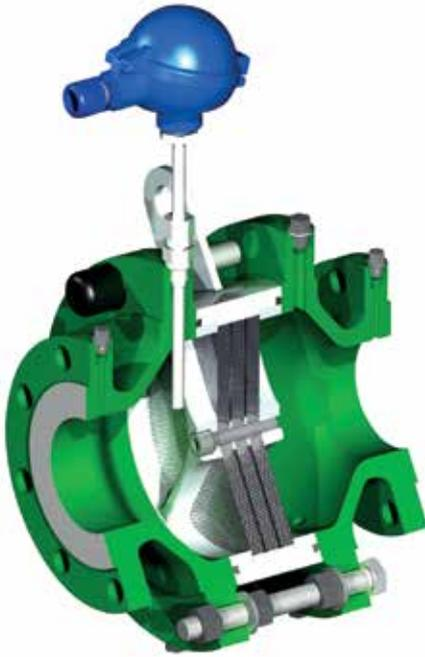
Durch die gewickelten Sperrelemente im Inneren der Flammensperren strömen gas- oder dampfförmige Prozessmedien im Regalärbetrieb nahezu ungehindert und ohne relevanten Druckverlust hindurch.
