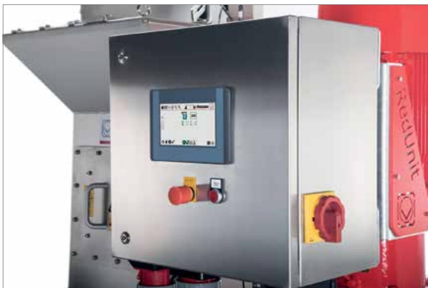
Das intelligente Steuerungssystem der Redunit wird über Touchscreen intuitiv bedient.
