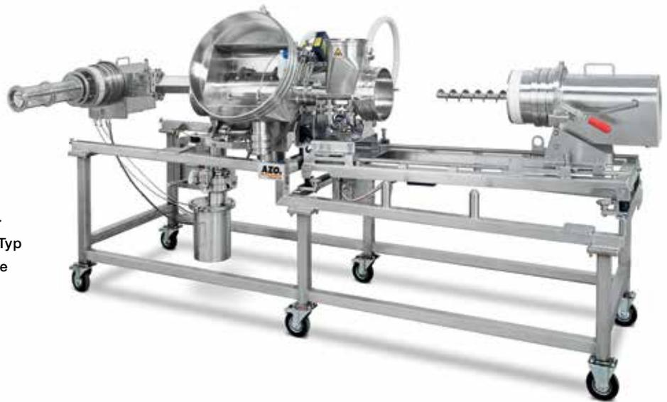
Gesamtansicht der Wirbelstrom-Siebmaschine vom Typ DA Vario Containment ohne Schutzsysteme.
