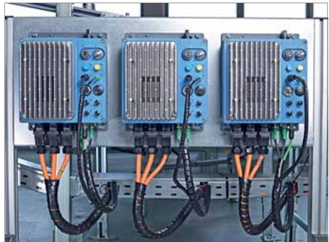
Mithilfe der integrierten PLC können die Feldverteiler der Antriebe selbständig Aufgaben lösen und Signale auswerten, um lokale Fehler zu erkennen.
