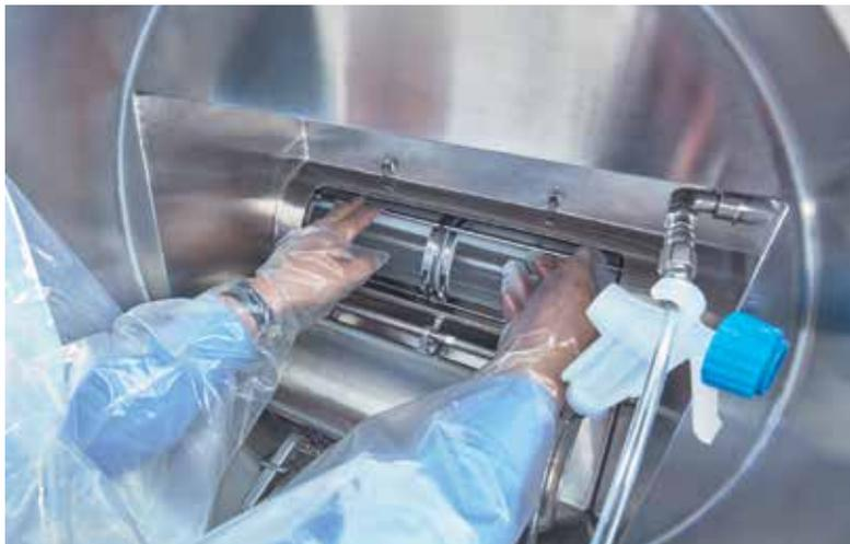
Nachdem die Klappe wieder geschlossen wurde, kann der anhaftende Staub mit Hilfe der Reinigungspistole gebunden werden. Das zum Auswischen benutzte Tuch wird in einer Seitentasche entsorgt.
