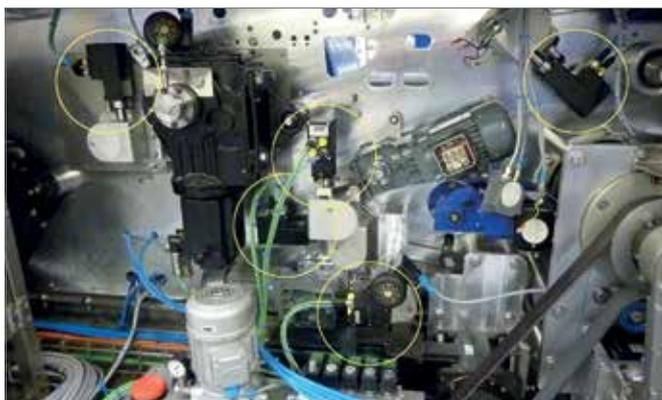
Fünf Siko-Positionierantriebe sorgen bei der Teigteil- und Wirkmaschine Soft Star CT dafür, dass der Formatwechsel automatisch erfolgt.
