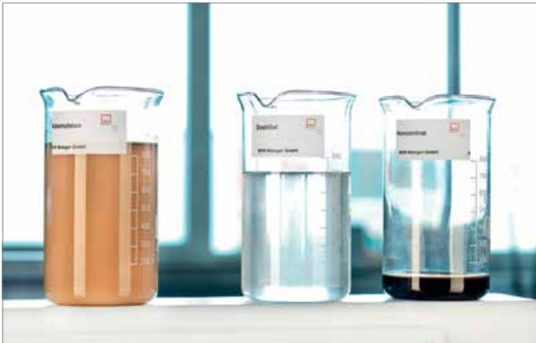
Die Altemulsion (links) lässt sich mit einem Verdampfer in das Destillat (Mitte) und Konzentrat (rechts) zerlegen – was Abfallvolumen und Entsorgungskosten spart.
