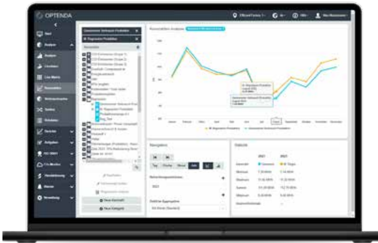
Kennzahlen-Analyse mit Regressionsmodell: Vergleich von theoretischem und gemessenem Energieverbrauch zur Bewertung von Effizienzmaßnahmen.
