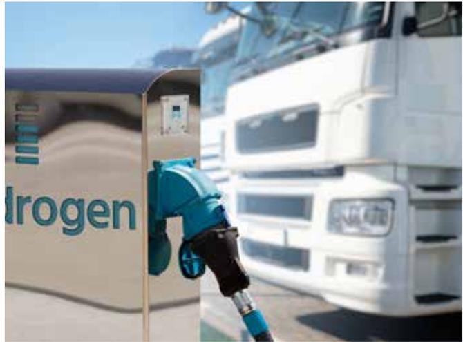
Aktuelles Entwicklungsziel im Schwerlastbereich ist eine Reichweite der Langstrecken-LKW von bis zu 1.000 Kilometern bei einer Betankung von 80 Kilogramm Wasserstoff.
