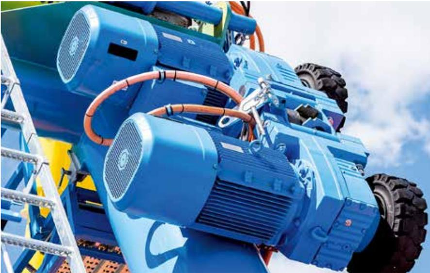
Die Stirnrad-Getriebemotoren der Baureihe R107 DRN180M4 haben eine Nennleistung von 18,5 kW.
