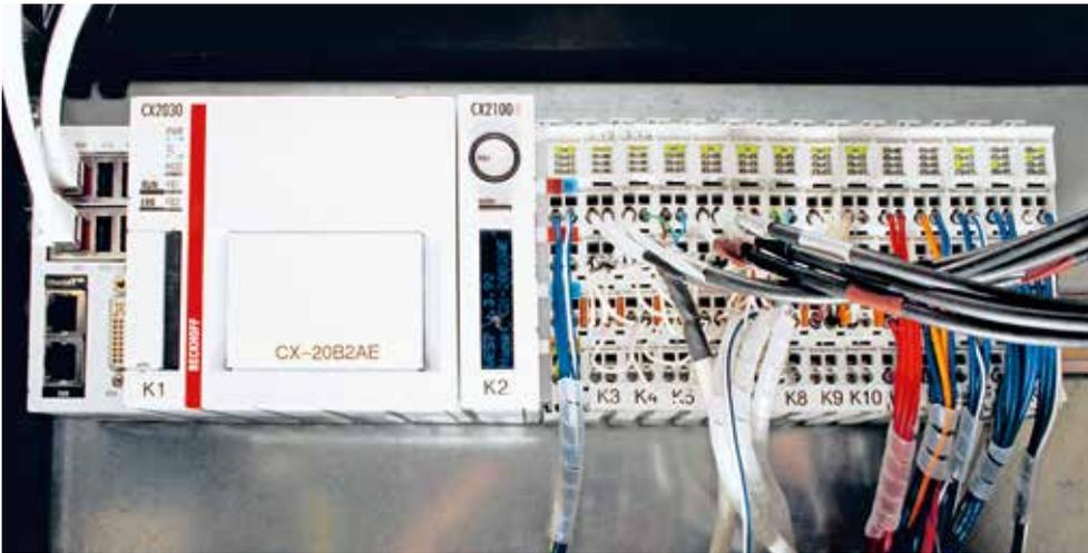
Bei der Umrichteremulation ermöglicht der Embedded-PC CX2030 kurze Regelungszykluszeiten von 50  $\mu$ s.
