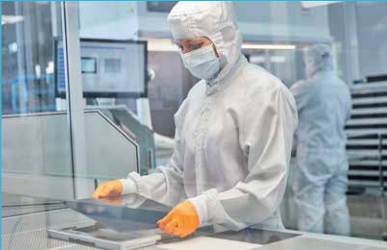
Reinraummontage von Display- und Touchpanel-Komponenten
