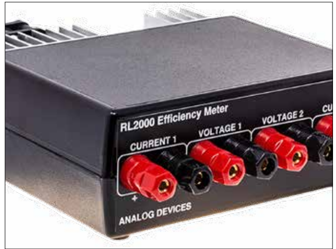
Ein EVAL-LTPA-RL2000 zum einfachen, schnellen und akkuraten Messen von Wandlungseffizienzen von Spannungsversorgungen
