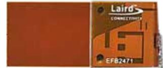
Relativ kostengünstige, stromsparende Verbindungsoptionen wie diese FlexPIFA 6E-Antenne von Ezurio (ehemals Laird Connectivity) werden verwendet, um Daten von Sensoren, die vor Ort installiert sind, an zentrale Datenerfassungspunkte zu übertragen.
