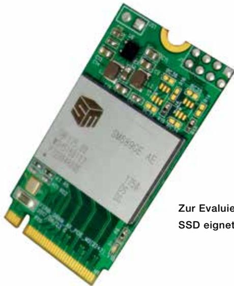
Zur Evaluierung einer Single-Chip-SSD eignet sich ein m.2-Board.
