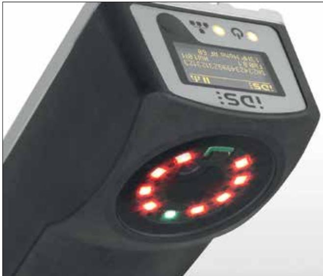
Das Embedded-Vision-System IDS NXT Vegas im IP65-geschützten Gehäuse ist auch als Boardlevel-Variante erhältlich.
