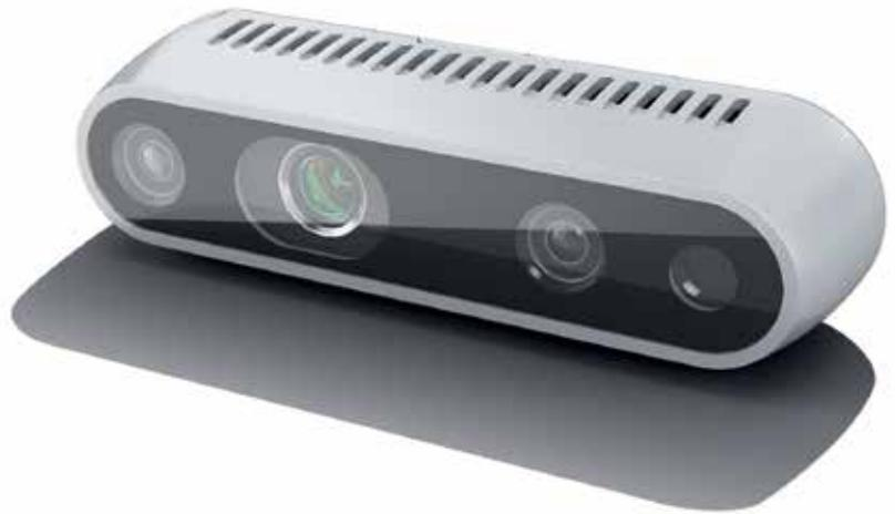
siert auf Stereo-Vision. Dabei werden zwei Kamerabilder im Infrarotbereich aufgenommen und anschließend wird nach identischen Pixeln auf den beiden Bildern gesucht. Über ein Triangulationsverfahren lässt sich anschließend die Tiefeninformation des betreffenden Pixels bestimmen. Mit dieser Technologie können OEMs und Vision-Ingenieure menschenähnliche 3D-Wahrnehmung in ihren Anwendungen implementieren, ohne dass dafür eine komplette Neuentwicklung erforderlich ist.
