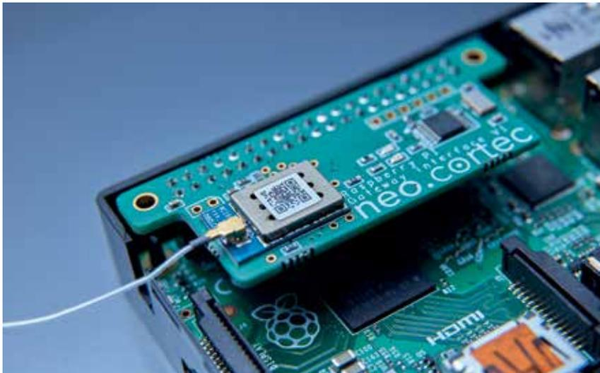
Das Neo-Gateway nutzt die integrierte Platine des Raspberry Pi. Mit dem Entwicklungs-Kit lassen sich NeoMesh-Netzwerke schnell und einfach testen.
