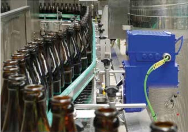
Das mechatronische Antriebssystem Movigear performance vereinigt Synchronmotor, Getriebe und Frequenzumrichter als vollintegrierte Einheit in einem kompakten Gehäuse. Es wurde speziell für die horizontale Förderertechnik entwickelt und kommt in zahlreichen Brauereien zum Einsatz. Die integrierte Kommunikationsschnittstelle ermöglicht die direkte Anbindung an die BMS-Steuerung.
