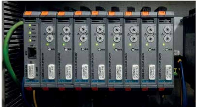
Im Schaltschrank der Schweißmaschine HSL 19 sorgt das Stromüberwachungssystem LCOS für den sicheren Betrieb.
