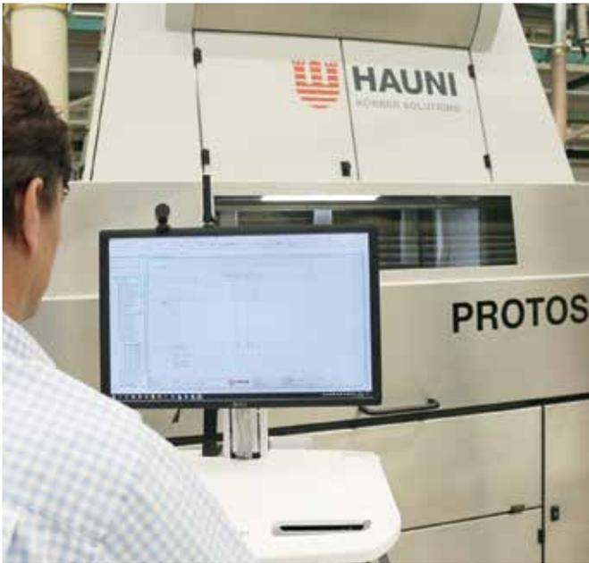
Mobile Arbeitsstation bei der Inbetriebnahme einer Secondary Maschine. Der Techniker hat direkt den Eplan Schaltplan im Blick.
