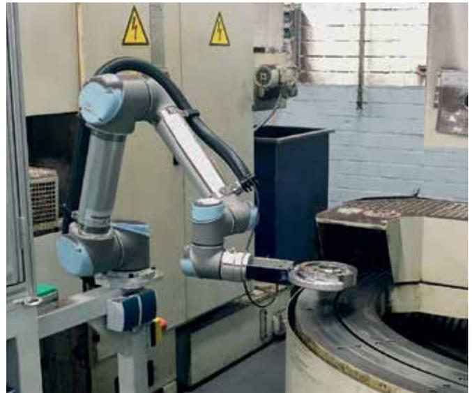
Der Roboter mit dem Greifer der Zimmer Group übernimmt den Transport des Bauteils zwischen der ersten und der zweiten Bearbeitungsmaschine sowie hin zur Nadelprägung.
