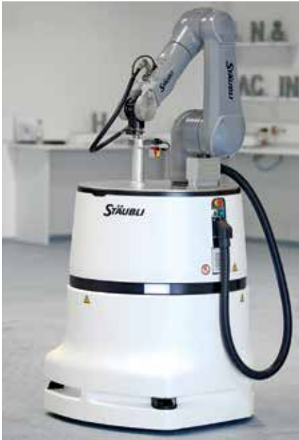
Das mobile Robotersystem HelMo navigiert eigenständig zu seinem Einsatzort, kann sich an Maschinen andocken und führt zuverlässig seine (Handlings-)Aufgaben aus.
