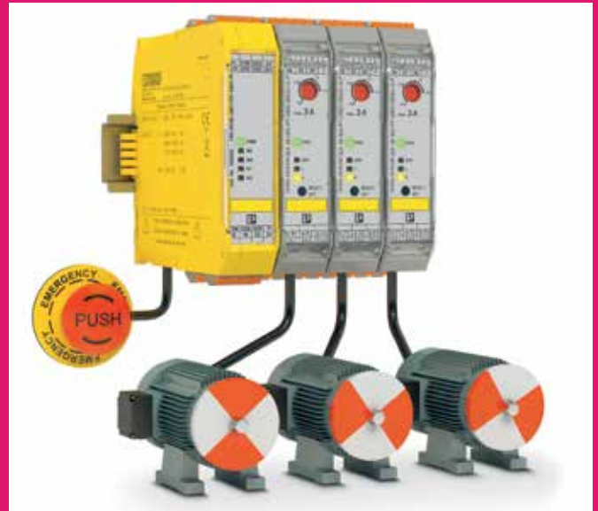
Einfache und sichere Gruppenabschaltung über ein vorgeschaltetes Sicherheitsrelais bis Kat.4/PL e/SIL 3 – das spart Platz und reduziert den Verkabelungsaufwand.
