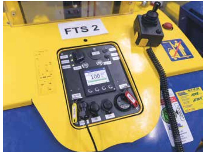
Das Bediengerät D1010 von Graf-Sytco visualisiert die aktuellen Batteriedaten.
