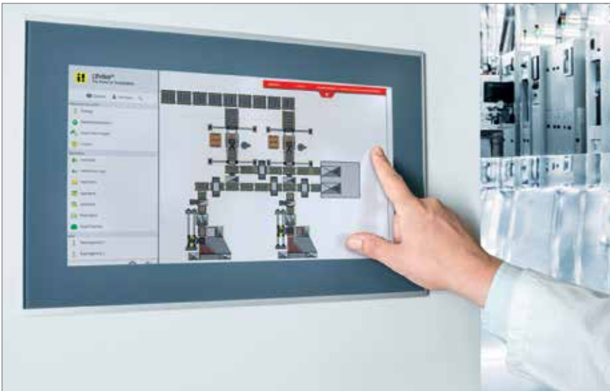
Web Panels sind eine neue Klasse von Bediengeräten, die mit Multi-Touch-Gesten so einfach wie Smartphones zu nutzen sind.
