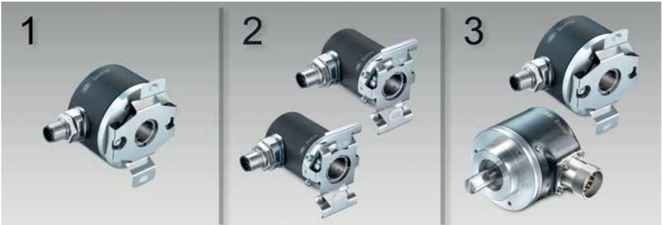
Eine Standardkomponente mit zwei Drehgebern in einem Gehäuse sowie 2-kanaliger Architektur aber gleicher Abtasttechnik ist die einfachste Möglichkeit, hohe Sicherheit in bewegten Arbeitsmaschinen zu schaffen (links). Alternativ kann der Anwender zwei baugleiche 1-kanalige Drehgeber verwenden (Mitte). Baumer bietet auch Standardkomponenten für die diversitäre Redundanz an: getrennte Gehäuse und unterschiedliche Abtastverfahren (rechts).
