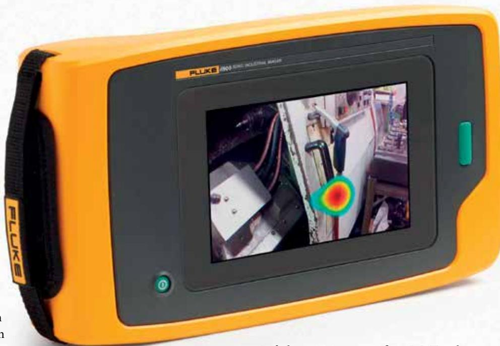
Auf dem 17,8 cm großen LC-Touchscreen wird ein Sichtbild mit einer SoundMap überlagert, um die Stelle des Lecks schnell lokalisieren zu können. Mit der intuitiven Bedienoberfläche können Techniker die Schallfrequenz eines Lecks eingrenzen, um laute Hintergrundgeräusche herauszufiltern. Innerhalb weniger Stunden kann das Team die gesamte Anlage prüfen, auch während des Betriebs bei Vollast. Die Bilder können zur Berichterstellung gespeichert und exportiert werden.
