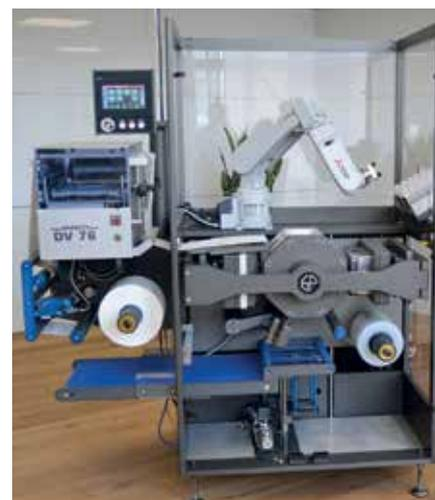
Mitsubishi Electric GOT2000 Bediengerät verbunden. Auch der optionale Melfa-Knickarmroboter wird über die SPS gesteuert. Alle Komponenten sind dabei über ein offenes CC-Link-Steuerungsnetzwerk verknüpft.
