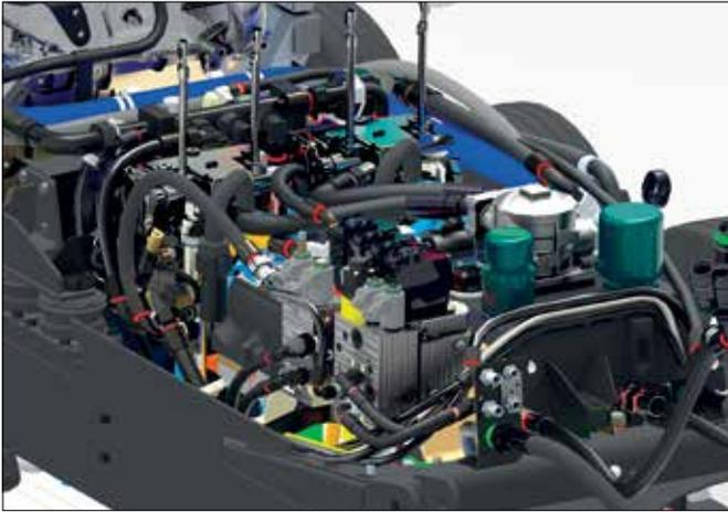
Mit den umfassenden Funktionen von XpresRoute lassen sich schnell Rohre mit Anschlussstücken definieren und auf engstem Raum verlegen.
