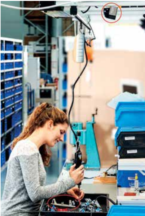
Der Visor Code Reader wird oben im Gestell angebracht (roter Kreis oben rechts) und liest die Teilecodes in einer festgelegten Position auf der Arbeitsfläche (roter Kreis unten links).
