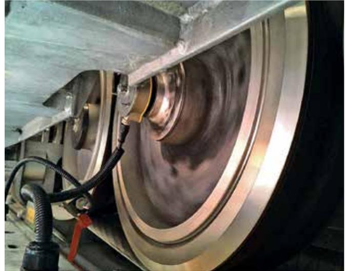
Der QR24-Drehgeber zählt die Umdrehungen der Hohlkehlrollen und sendet die Daten an eine Steuerung.
