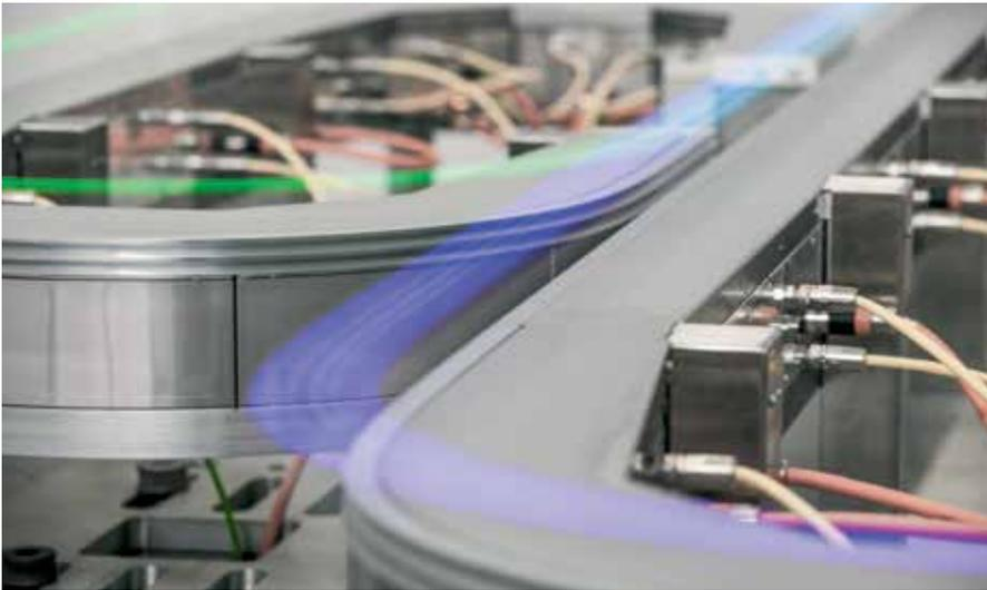
Mithilfe einer Weiche kann der Produktstrom auf mehrere parallele Bearbeitungsstationen verteilt und anschließend wieder zusammengeführt werden. Zeitkritische Prozesse lassen sich damit wesentlich beschleunigen. Die Durchlaufzeit verringert sich, die Produktivität steigt.
