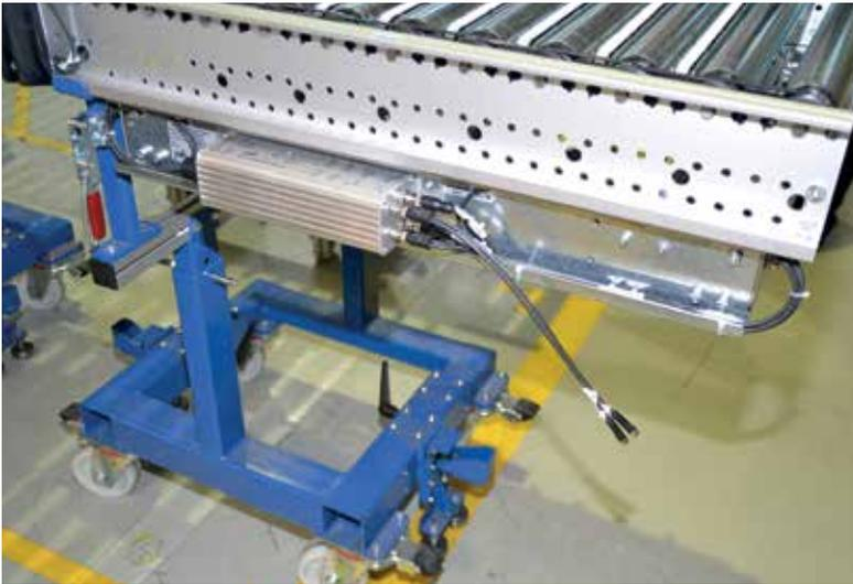
Hier sind die neuen S400-Anschlussleitungen an einem Teilstück einer Förderanlage zu sehen.
