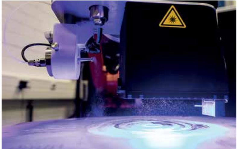
Ein Ultraschallzerstäuber (links im Bild) erzeugt ein definiertes Wasseraerosol, das auf die Probenoberfläche aufgesprüht wird.
