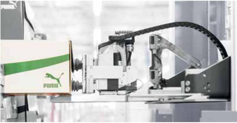
Per Unterdruck werden die Waren aus dem Regal genommen. Eine Metallzunge schließt vor dem Ansaugen die Lücke zwischen Regalboden und dem Logistikroboter. Sowohl das Ausfahren der Zunge als auch das Bewegen des Greifarms übernehmen bürstenlose DC-Servomotoren von Faulhaber.
