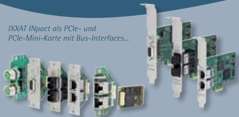
IXXAT INpact als PCIe- und PCIe-Mini-Karte mit Bus-Interfaces...
