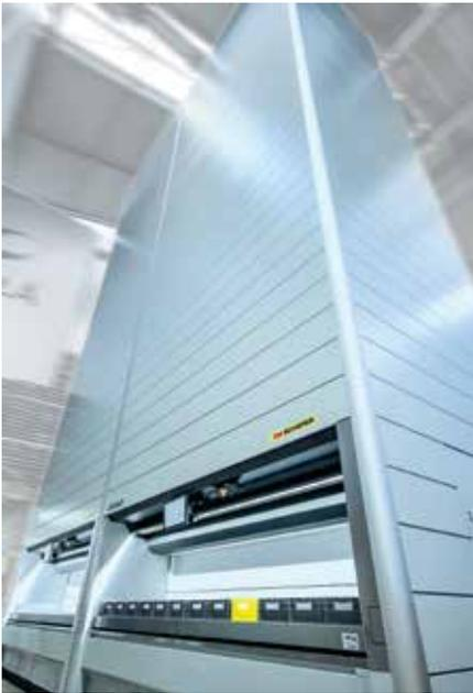
In den Logimat-Türmen sind übereinander Schubladen gestapelt, die sich motorgetrieben herausziehen und nach unten fahren lassen.
