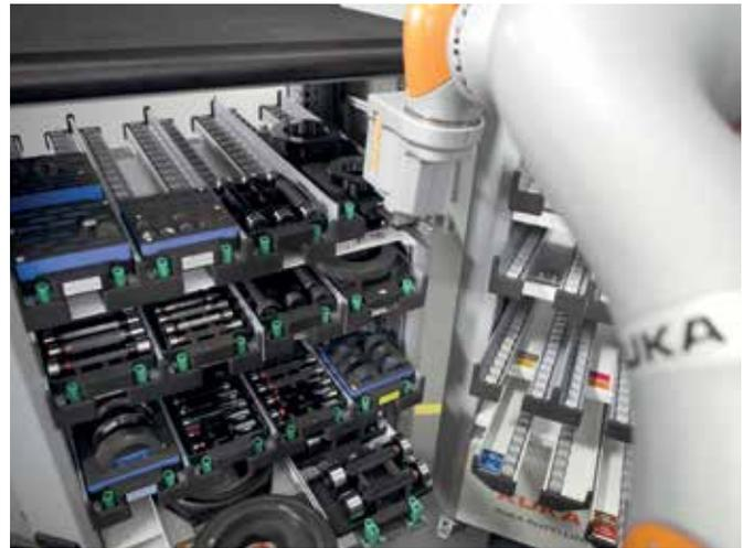
Automatisierter Messprozess: sensibler LBR iiwa kann verschiedene Messmittel handhaben.
