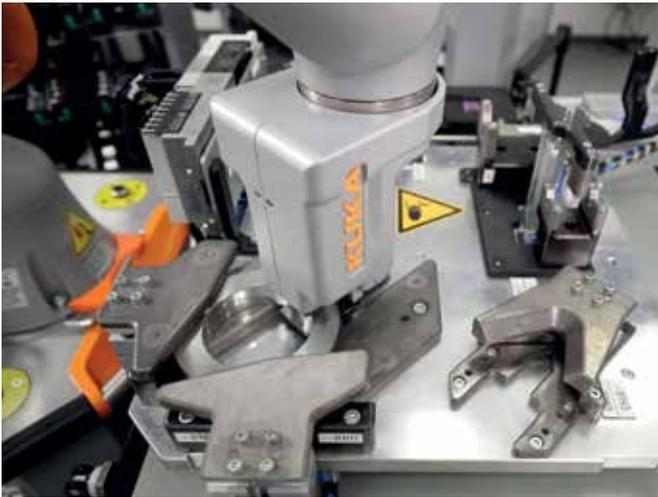
Beim automatisierten Messen spannt der Kuka LBR iiwa verschiedene Messmittel in Aufspannvorrichtung.
