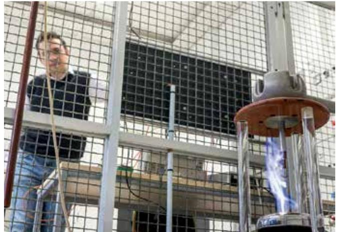
In den Versuchszellen führen die Wissenschaftler unter anderem Tests zur Durchschlagsfestigkeit von Werkstoffen durch.
