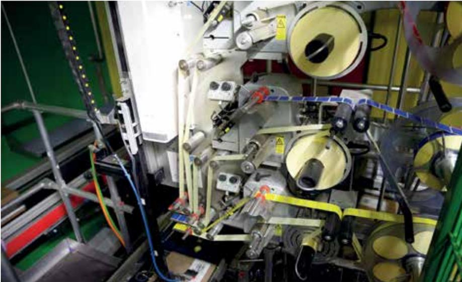
Bei Apetito etikettieren Etikettenspender vom Typ Alpha Compact von Bluhm Systeme ganz ohne Einhausung zuverlässig die fertig kommissionierten Kartons bei  $-24^{\circ}\text{C}$ .
