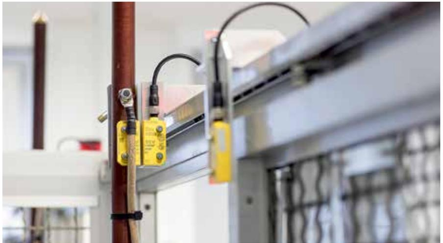
Sicherheitssensoren vom Typ Eden – mit den komplementären Elementen Adam und Eva – überwachen die Türen der Versuchszellen und die Erdungsstange.
