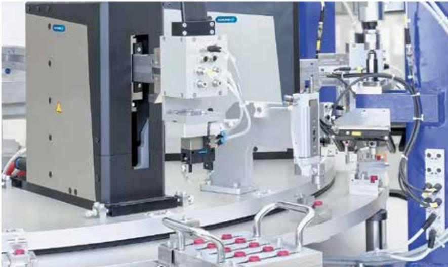
Die Schunk-Pick-&-Place-Einheiten mit integrierten Mikroventilen gewährleisten kurze Taktzeiten, eine hohe Flexibilität und sie sind ausgesprochen energieeffizient.
