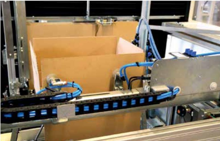
Per Druckluft wird der Karton ins Innere befördert, gedreht, die Bodenlaschen werden gefaltet, geklebt und dann nach draußen transportiert.
