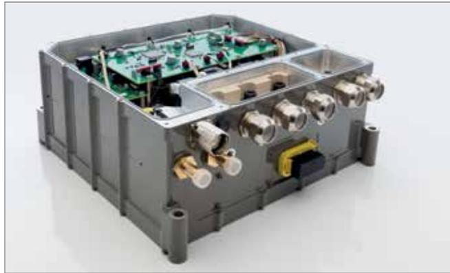
Der Traktionsumrichter von Wittenstein mit einem Nennstrom von 240 A, der den notwendigen Drehstrom für die E-Maschine liefert, stellt in einem überlast-geschützten Spannungsbereich von 610 bis 730 VDC eine elektrische Dauerleistung von 185 kVA zur Verfügung.
