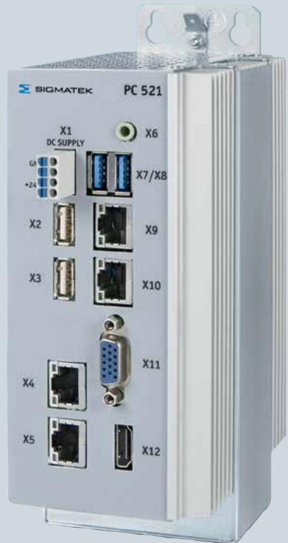
Um diese Aufgabenstellungen zu erfüllen, hat Sigmatek den Datenerfassungs-PC 521 entwickelt. Die vom PC aktiv von der Maschine oder Anlage abgegriffenen Daten werden lokal auf der integrierten Solid State Disk abgespeichert. Bis zu 8 GByte DDR RAM sorgen für ausreichenden Puffer zur Abarbeitung großer Datenmengen.
