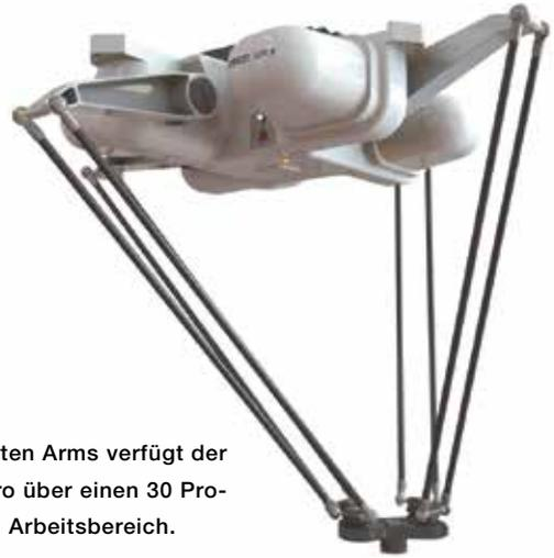
Dank des vierten Arms verfügt der Omron-Quattro über einen 30 Prozent größeren Arbeitsbereich.
