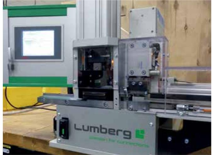
Von Lumberg entwickelte Halbautomaten – ebenfalls mit dem CC-4000 ausgestattet – ermöglichen ein effizientes und qualitätsüberwachtes Konfektionieren von Kabelsätzen mit Steckverbindern in Schneidklemmtechnik.
