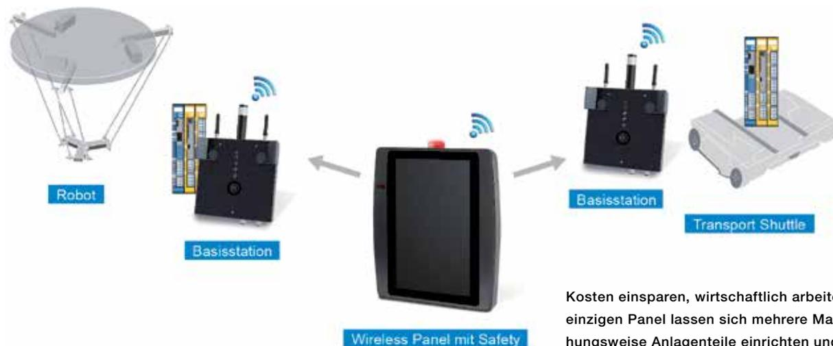
Kosten einsparen, wirtschaftlich arbeiten: Mit einem einzigen Panel lassen sich mehrere Maschinen beziehungsweise Anlagenteile einrichten und steuern.
