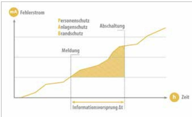
Informationsvorsprung durch Differenzstromüberwachung
