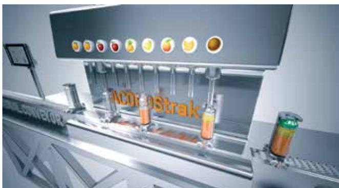
Acopostrak ist ein flexibles Transportsystem, das über eine rein elektronische Weiche verfügt, über die sich Produktströme trennen und wieder zusammenführen lassen.
