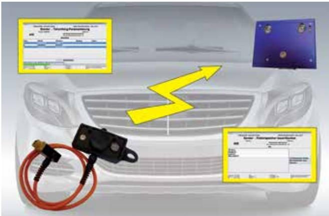
HS Kairo kann durch transparente Objekte aller Art senden und empfangen. Das System nutzt bei der Master- und Slave-Schnittstelle blaues und rotes Licht.
