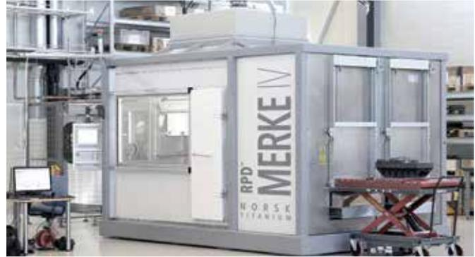
Norsk Titanium AS, Anbieter von additiver Fertigungstechnik für luft- und raumfahrttaugliches Titan, rüstet seine Rapid-Plasma-Deposition-Maschinen mit dem CNC-System MTX aus.
