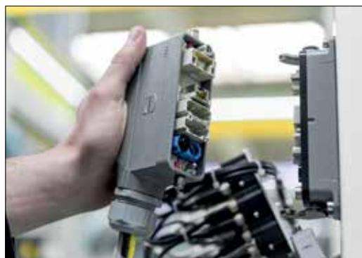
**Modulare Steckverbinder machen Maschinen und Anlagen flexibler für Umrüstung und Erweiterung.**
