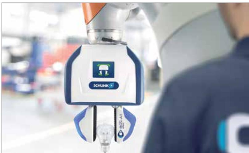
Über taktile Sensoren in den Fingern bestimmt der Co-Act JL1 Greifer die Greifkraft, die auf ein Objekt wirkt. Dadurch können auch zerbrechliche Gegenstände zuverlässig gehandhabt werden.
