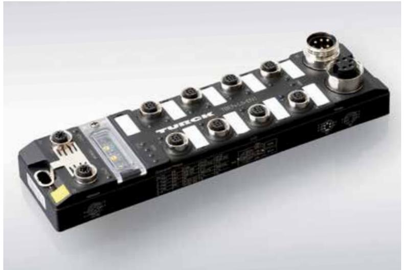
Das Spanner-Modul TBEN-L5-EN1 fungiert als Slave für beide Steuerungen und ermöglicht so eine direkte Master-Master-Kommunikation. Dank seiner Multiprotokoll-Technologie arbeitet er in Profinet-, Ethernet/IP- und Modbus-TCP-Netzen.
