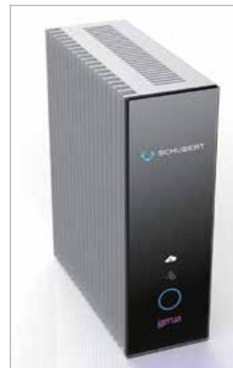
Das GS.Gate bietet flexible Analysemöglichkeiten direkt an den Maschinen und kombiniert die Funktionen eines Edge-Gateways mit einer Firewall.
