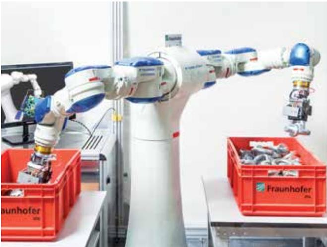
Dank der Bildverarbeitungssoftware bp3 ist dieser zweiarmige Roboter in der Lage, Bauteile aus einer Kiste zu greifen und definiert abzulegen.
