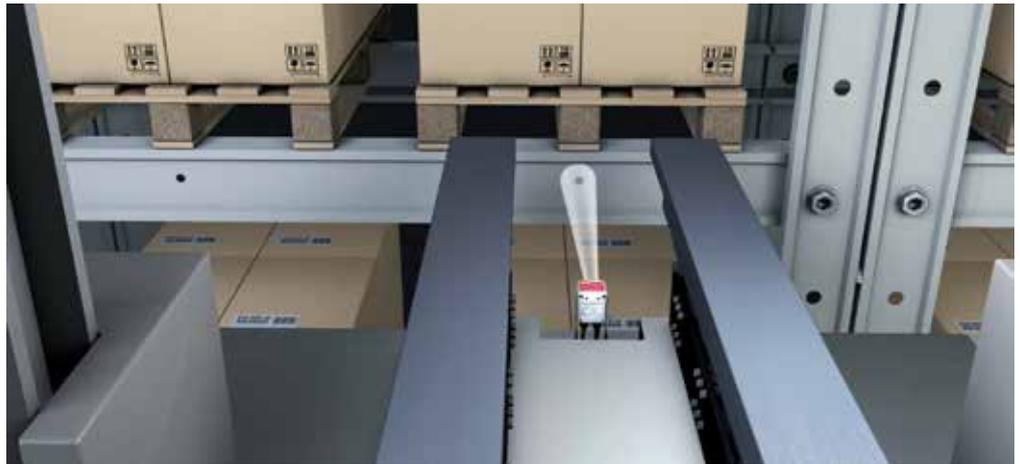
Der smarte Sensor detektiert kreisrunde Löcher beziehungsweise Reflektoren in einem einfachtiefen Riegel oder Steher eines Palettenlagers und bestimmt die Positionsabweichung von Paletten oder Behältern in X- und Y-Richtung relativ zur Sollposition.
