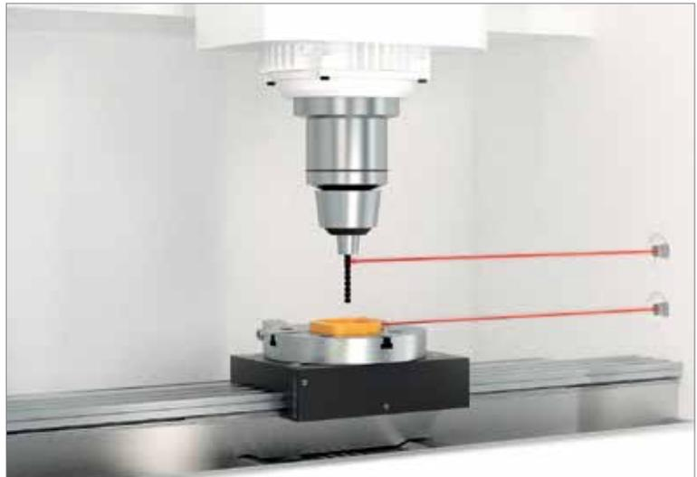
rührungslos arbeitende Sensor aus einer äußerst kompakten Basiseinheit, an die bis zu drei Miniatur-Sensorköpfe mit Glasfaserkabel angeschlossen werden können. Der IDS3010 kann direkt auf dem Objekt, beispielsweise einem Spindelkopf, einem Werkzeug oder einem Messtaster messen. Dabei erreicht er bei Messdistanzen von bis zu fünf Metern eine Auflösung im Nanometerbereich.
