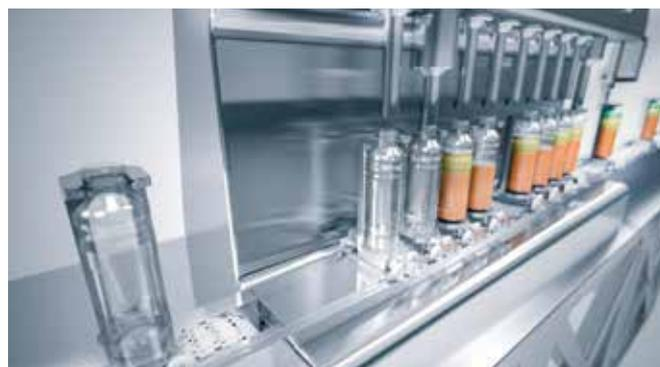
Führungsschienen ermöglichen einen nahtlosen Übergang vom konventionellen Förderband zum intelligenten Acopostrak.
