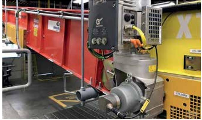
Das intelligente Nord-Antriebssystem mit Industrial-Ethernet-Schnittstelle ermöglicht eine Fernsteuerung der Anwendung.
