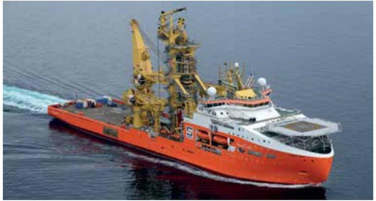
Rohrlegerschiffe sind schwimmende Pipeline-Fabriken mit bootseigener Schweißerei sowie Anlagen zur Materialprüfung und Beschichtung.
