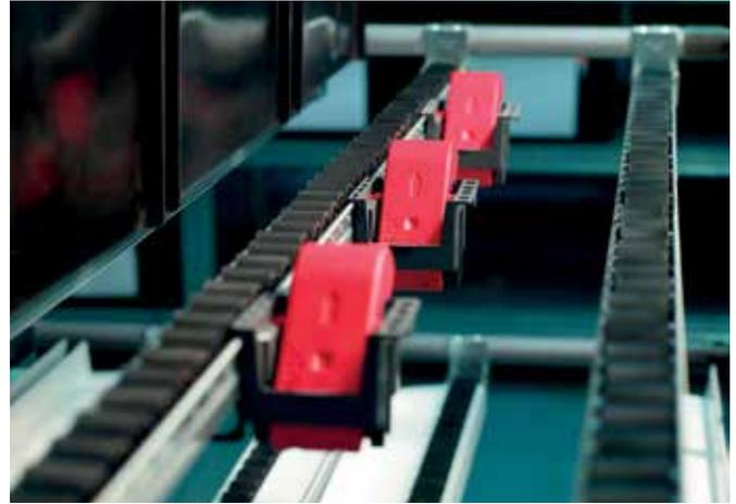
Bei Schnellläufern ermöglichen mehrere Funksensoren pro Reihe eine bedarfsgerechte Steuerung des Nachschubs.
