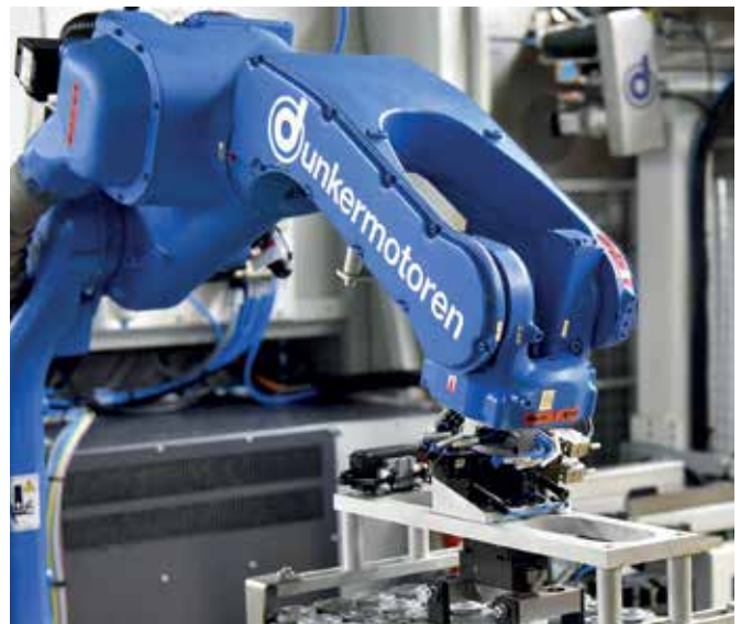
Der Werkstückträgergreifer garantiert die sichere Aufnahme und den schnellen Transport der Teile.
