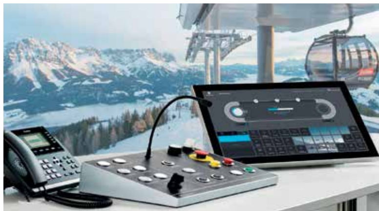
Das SCADA-System läuft auf einem kundenspezifischen Terminal von Bachmanns OT1300-Serie mit einem 21,5 Zoll großen TFT mit Full-HD-Auflösung und kapazitivem Touchscreen.
