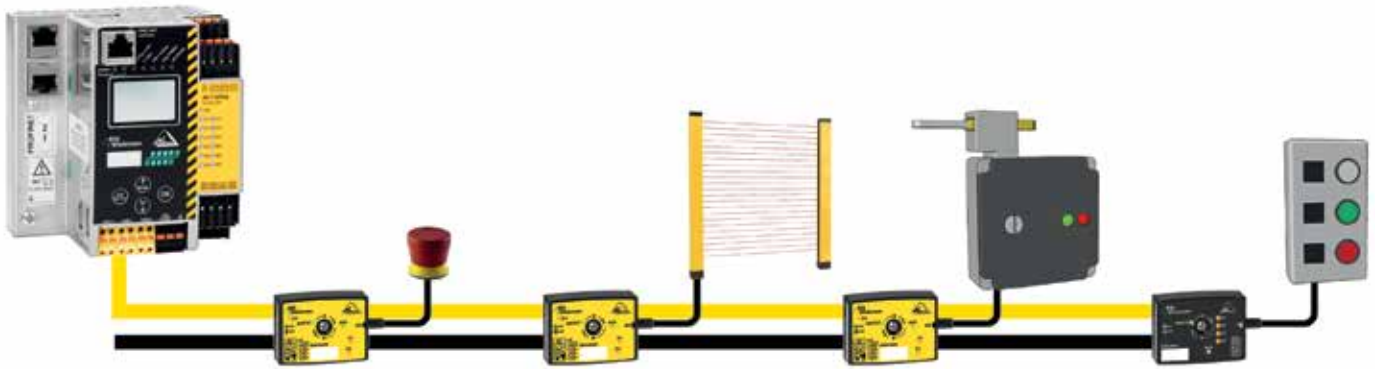
Mit aktiven Verteilern lassen sich beliebige Sensoren, Taster oder Schalter sehr einfach AS-i fähig machen.
