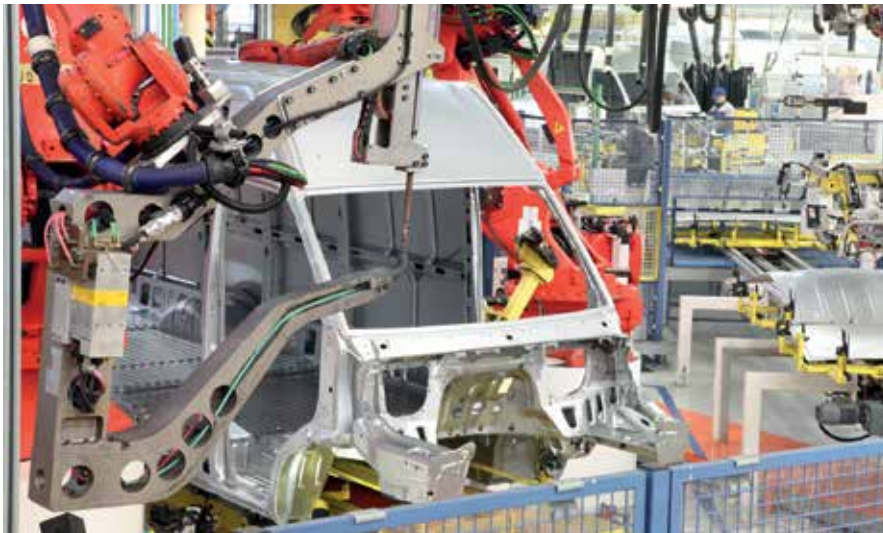
Die Kühlung der Schweißzangen überwachen IFM-Durchflusssensoren vom Typ SBY.
