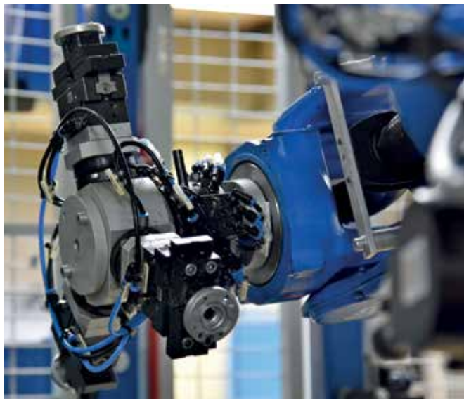
Das Greifsystem besteht aus drei im Abstand von 120 Grad angeordneten Einzelgreifern.
