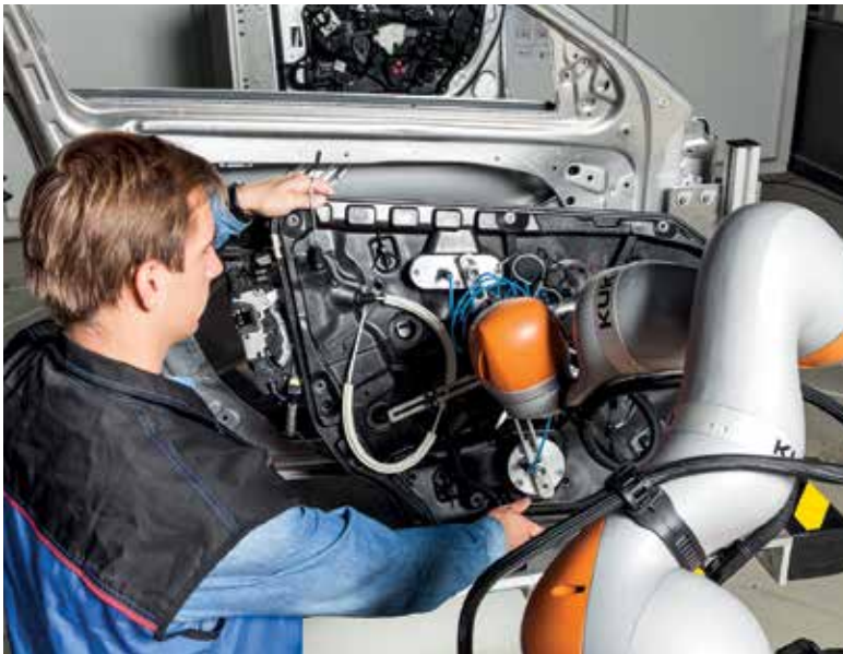
In MRK-Kollaborationsszenarien arbeiten Mensch und Roboter parallel im gleichen Arbeitsraum beziehungsweise agieren direkt miteinander.
