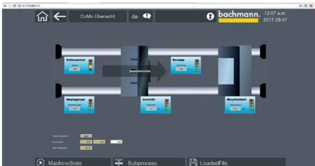
Der Maschinenstatus wird anhand eines Ampelsystems intuitiv dargestellt.
