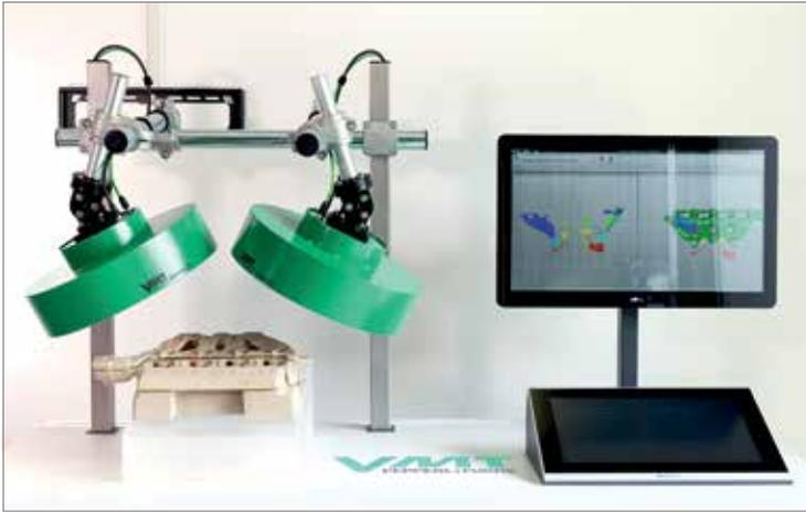
Bis ins kleinste Detail: Mit einer rotierenden Bewegung erfassen vier perfekt aufeinander eingespielte SpinScan3D-Sensoren das exakte Abbild eines Sandkerns für den Motorblockguss.
