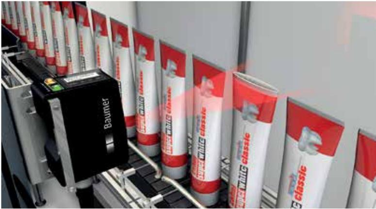
Direktes Aussortieren schlecht verschweißter Zahnpastatuben erfolgt durch Höhenmessung der Schweißnaht.
