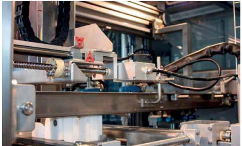
Die kompakten Antriebe regeln automatisch die Höhen- und Breitenverstellung zur Tray-Formung.
