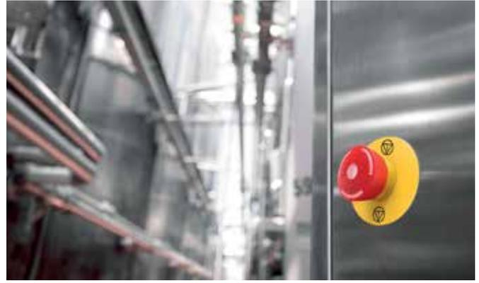
Die Not-Halt-Schalter von EAO haben zwangsöffnende Kontakte und unterbrechen den Stromkreis zuverlässig.
