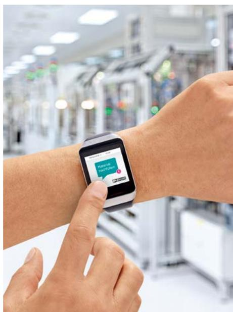
Bild 2: Statusmeldungen und Alarmer werden direkt an eine Smartwatch gesendet, die der Bediener an seinem Handgelenk trägt
