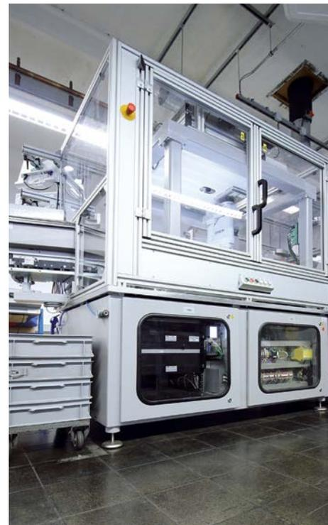
Bild 1: In der vollautomatischen Anlage werden die Bestandteile von Gehäusen anwenderspezifisch verpackt
