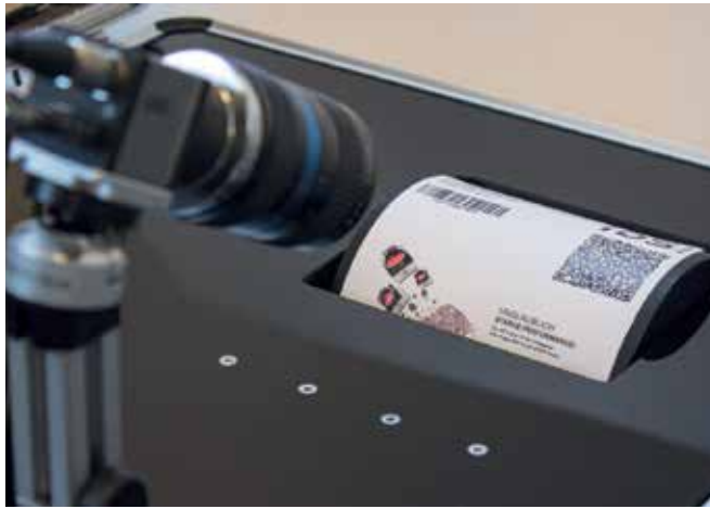
Eine Flächenkamera lässt sich softwareseitig auch in eine Zeilenkamera verwandeln.
