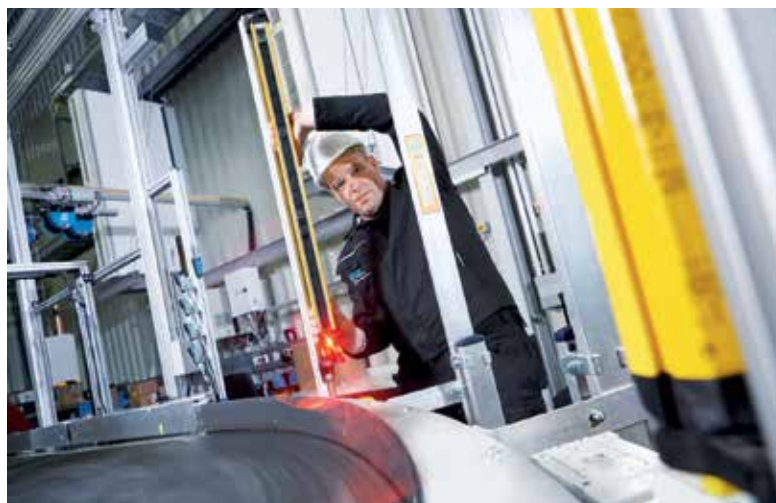
Die Inspektion einer Maschine und Anlage ist nach der vorausgegangenen Maschinensicherheitsbewertung eine detaillierte Prüfung einer einzelnen Schutzeinrichtung, die sich aus den Forderungen der Betriebssicherheitsverordnung ableitet.
