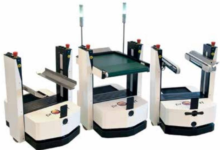
InSystems entwickelt individuelle Transportroboter für Lasten von 30 bis 1.000 kg und implementiert sie als Flotte in die vorhandene Produktionssteuerung.
