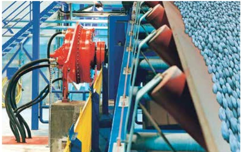
Das Förderband in einer Eisenerzmine läuft dank vorausschauender Zustandsüberwachung des Antriebs zuverlässig.
