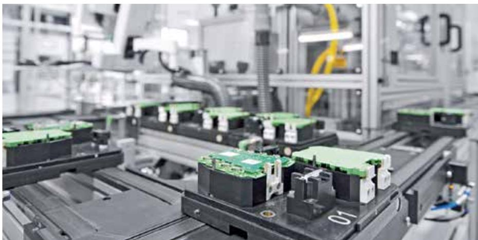
Ein RFID-Tag im Werkstückträger verbindet das Produkt mit den Informationen im übergeordneten System.
