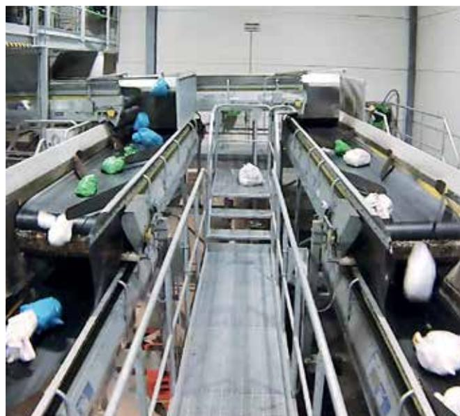
In der Optibag-Anlage werden die farbigen Müllbeutel von Kamerasystemen erfasst und über mechanische Auswerfer zu den weiteren Verarbeitungsstationen transportiert.
