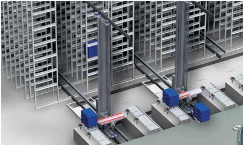
Regalbediengeräte (RBG) bestehen vereinfacht dargestellt aus den Komponenten Fahrwerk, Mast, Hubschlepper mit Lastaufnahmemittel und Kopftraverse.
