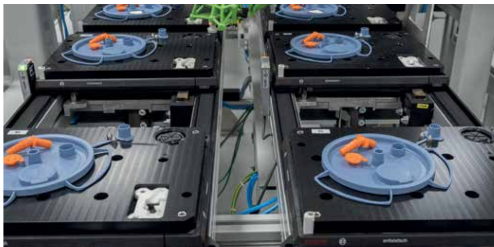
Industrial-RFID-System BIS M von Balluff: Werkstückträger identifizieren sich an den Schreib-/Leseköpfen und tauschen Daten aus.
