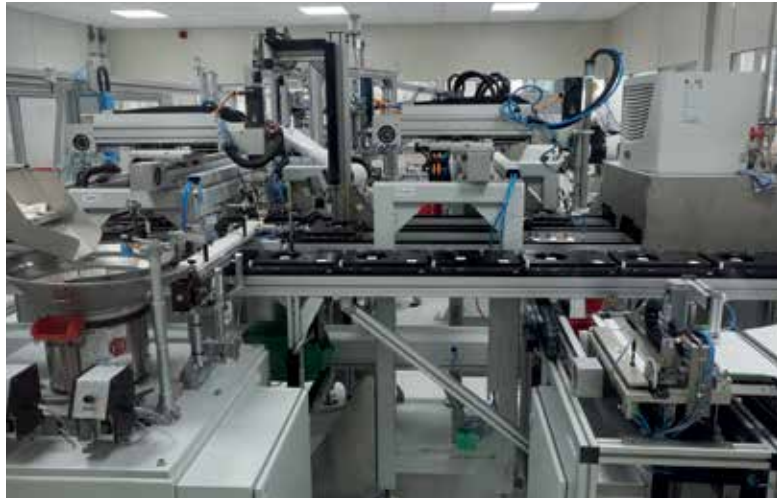
Verkettete Anlage: In 52 Prozessschritten wird aus einzelnen Bauteilen ein Einweg-Auffangsystem.
