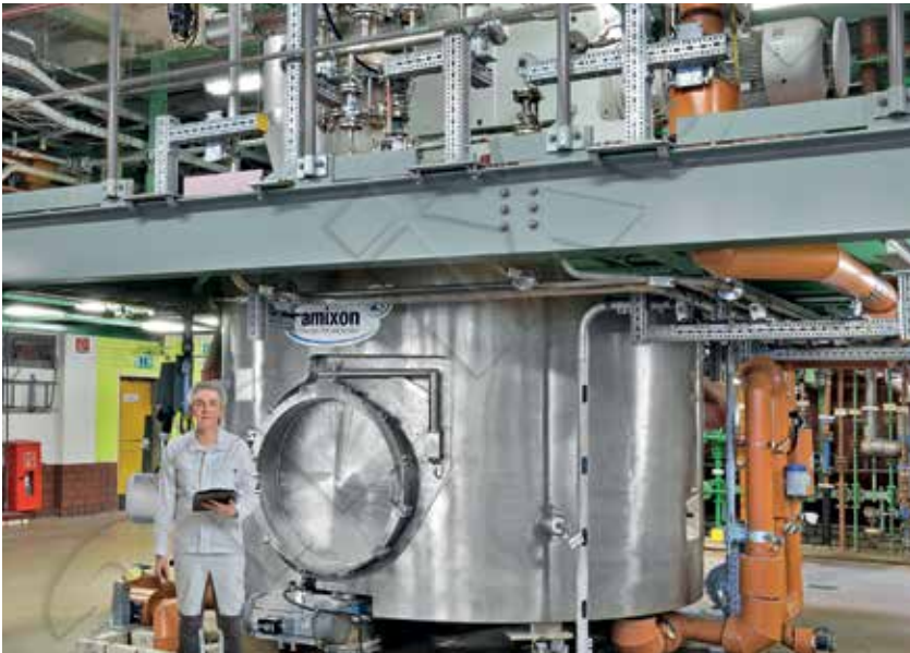
Die Trocknung mit dem Synthesereaktor VMT 12000 erfolgt schonend aber schnell, auch wenn verschiedenste rheologische Konsistenzen auftreten.
