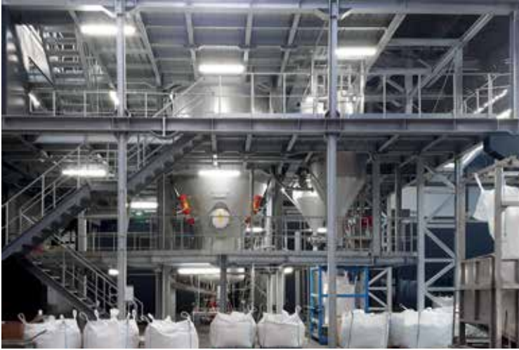
Die multifunktionale Glatt-Wirbelschicht-anlage dient der Granulation und dem Coating von Düngemitteln im kontinuierlichen und batchweisen Betrieb.
