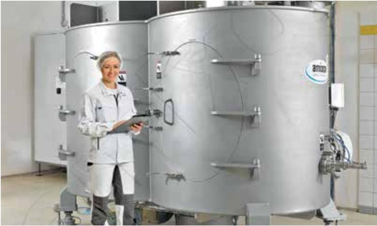
Besonders schonendes Mischen bei geringer Drehfrequenz ist im Doppelwellenmischer von Amixon möglich.
