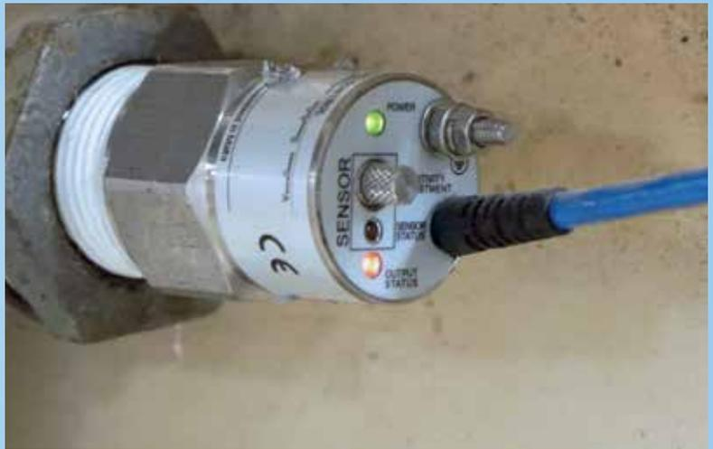
Der kapazitive Sensor garantiert innerhalb der Mischer einen sicheren Medienfluss trotz auftretender Vibrationen.
