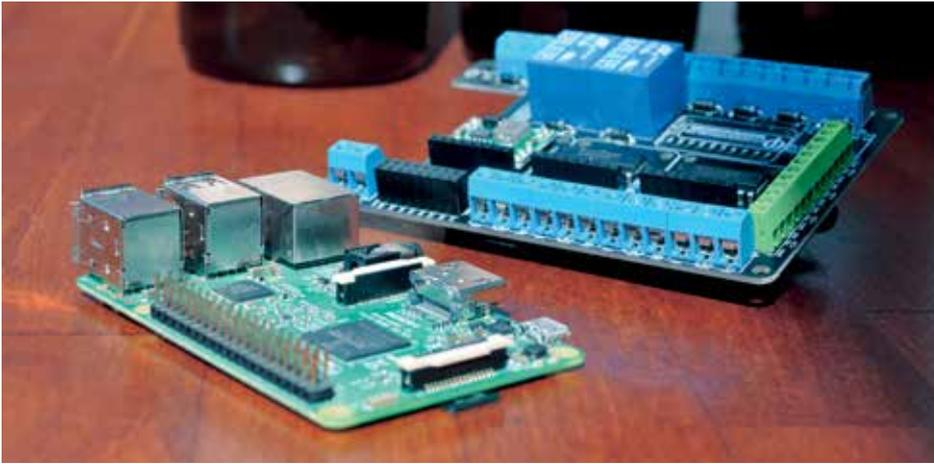
Raspberry Pi mit CraftBeerPi-IO-Platine: Zur weiteren Verbesserung der Brausteuerung nutzt die Gutshofbrauerei „Das Freie“ jetzt industrielle Steuerungstechnik.
