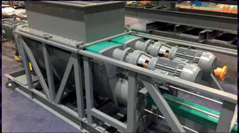
Das neue Transportkonzept besteht aus einer Exzentrerschneckenpumpe, zwei Doppelwellenzerkleinerer sowie einer Rohrleitung von etwa 230 m Länge.
