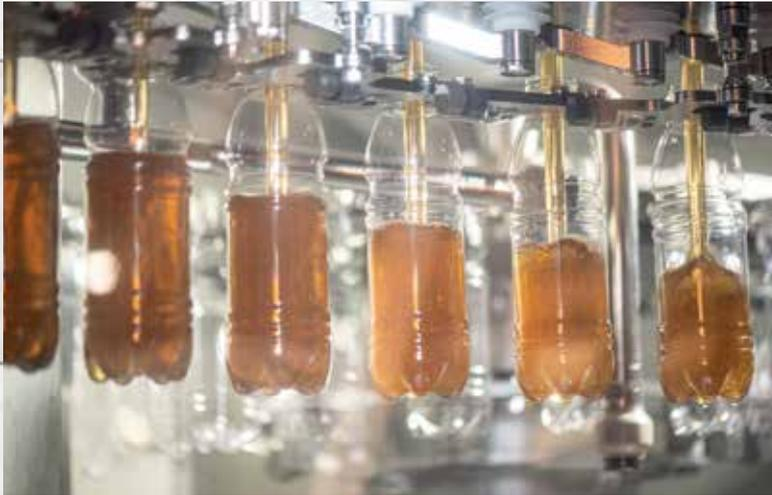
Der Contipure AseptBloc DN bei Spitz entkeimt mit gasförmigem Wasserstoffperoxid und verarbeitet 24.000 Behälter pro Stunde.
