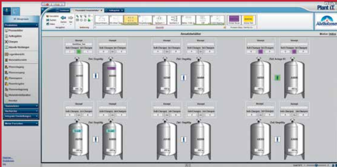
Prozessbild der Ansatzbehälter: Plant Batch iT rechnet die jeweilige Charge automatisch auf die Restmenge herunter und gewährleistet somit einen möglichst effizienten Produktionsprozess.
