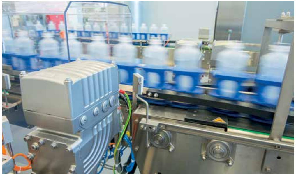
Etwa 400 mechatronische Movigear-Antriebe sind bei B. Braun im Einsatz.
