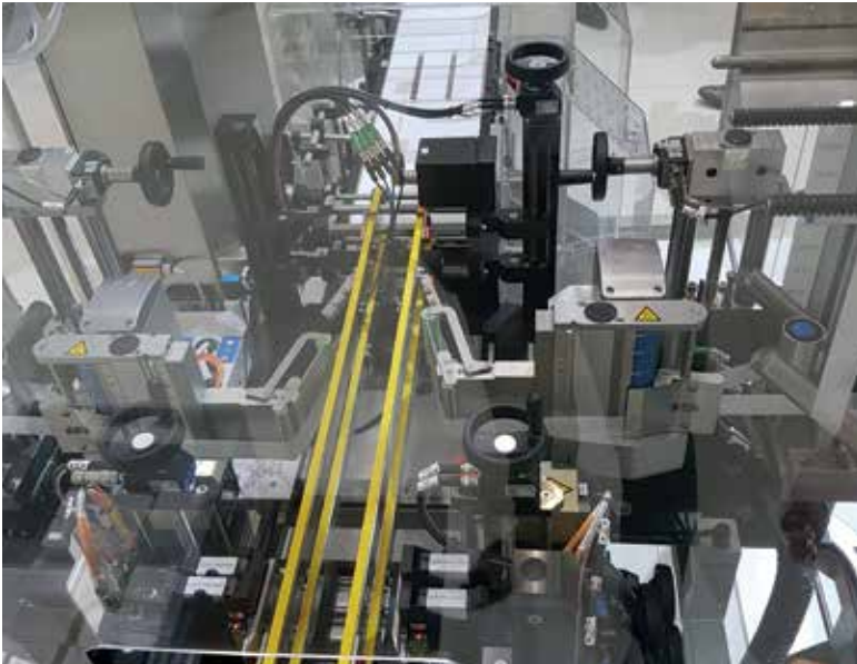
Bei diesem TQS-Serialisierungssystem kommen busfähige elektronische AP05-Positionsanzeigen zum Einsatz.
