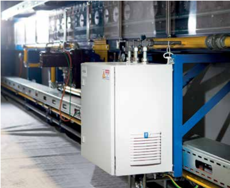
Rollenherdofen sind für das Presshärteverfahren hochfester Stähle geeignet, die als sicherheitsrelevante Strukturteile Verwendung finden.
