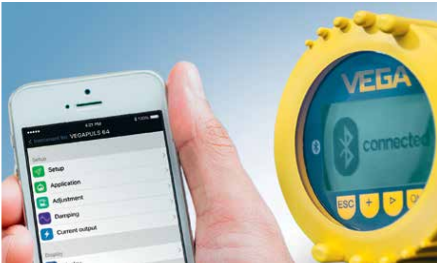
Die Bluetooth-Funktion ermöglicht es, den Sensor aus einer Entfernung von etwa 25 m drahtlos zu bedienen.
