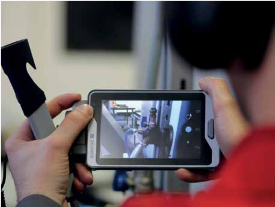
Mit der integrierten Kamera können Bilder der Leckage aufgenommen werden.
