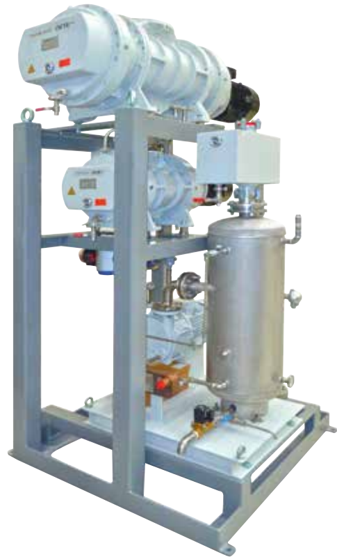
Dreistufiger Pumpstand von Pfeiffer Vacuum für Destillationsprozesse.
