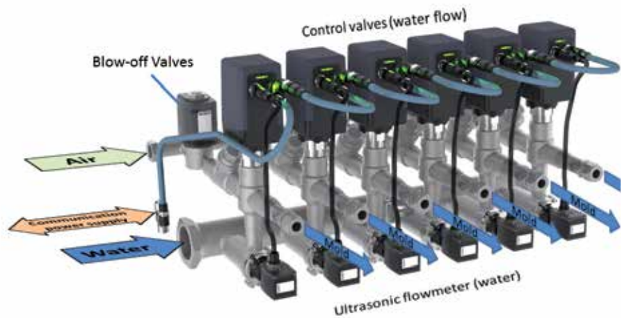
Kühlung von Druckgussformen mit Ausblasfunktion und digitaler Kommunikation.
