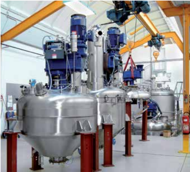
Solidmix Vakuumkontakttrockner mit verschiedenen Rührsystemen: links Ekato Feststoff Paravisc und rechts Ekato Isopas.
