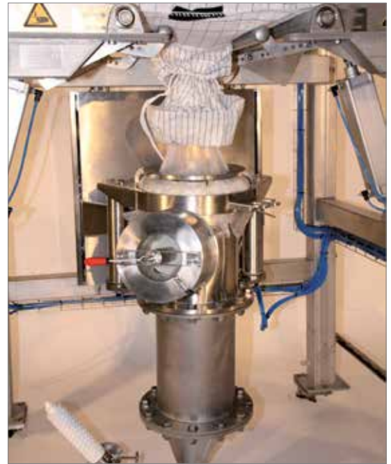
Das neue Big-Bag-Anschluss-System erlaubt ein leichtes, ergonomisches Entleeren bis zu einem Containmentlevel von OEB 4.
