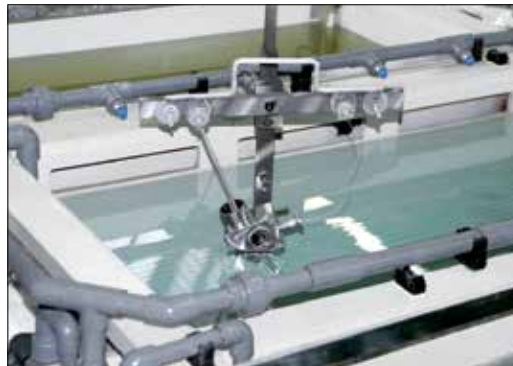
GEMÜ Block im Tauchbecken beim E-Polieren
