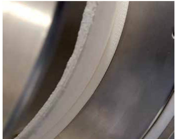
Filterkuchen (5 mm) einer schwer zu filtrierenden Suspension
