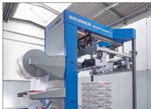
Die BEUMER stretch hood A überzieht palettierte Ware mit einer Stretchhaubenfolie.
