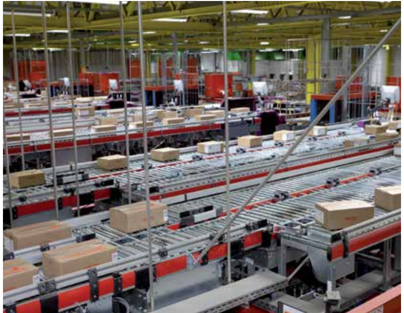
Ausgeklügeltes Logistiksystem: Die Anlagensteuerung gibt ganz genau die Reihenfolge und Sortierung der Kartons vor.
