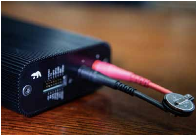
Eine CR2032-Knopfzelle, die an den Otii Arc angeschlossen ist, um ein Entladeprofil zu erstellen
