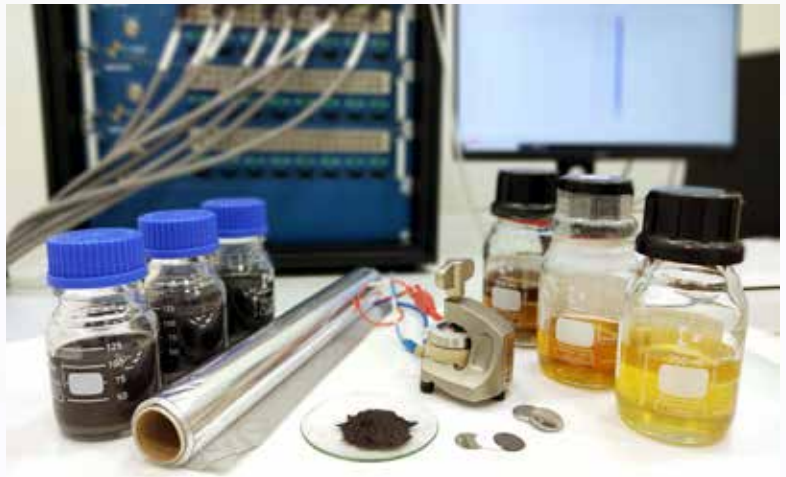
Die wichtigsten Komponenten einer Aluminium-Ionen-Batterie: Graphitpulver, Aluminium-Folie und ein spezieller Elektrolyt, der aus einer dedizierten bei Raumtemperatur flüssigen Salzschnmelze besteht.
