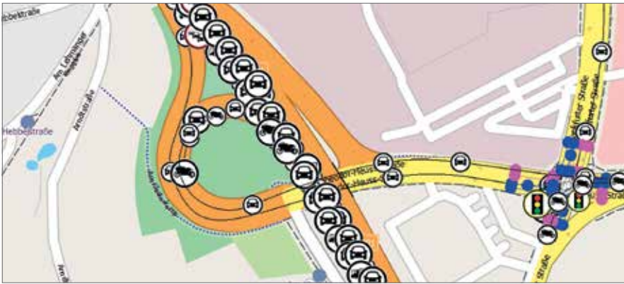
Detailsicht auf eine Stausituation an einer Autobahnabfahrt mit sich anschließender Ampelkreuzung. Die Anzahl der V2X-Netzknotten steigt in einem solchen Fall schnell an und erfordert entsprechende Tests.
