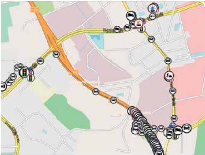
Ein realitätsnahes Verkehrsszenario mit vielen V2X-Netzwerkknoten und verschiedenen Nachrichtentypen, einer Stausituation und Ampeln. Im Laborprüfstand waveBEE hive können solche komplexen Testszenarien geprüft werden.
