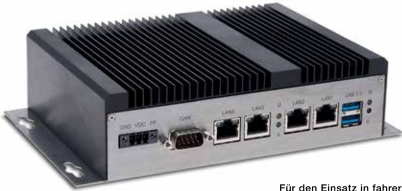
Für den Einsatz in fahrerlosen Transportsystemen (FTS) wurde der Box-PC FTS-Computer OEM M-81 nach EN 1175-1:1998+A1:2010 ausgelegt, der Norm für fahrerlose Flurförderzeuge.
