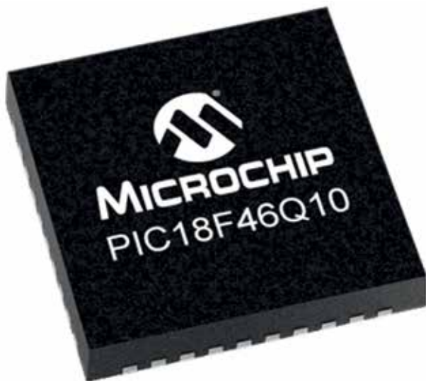
Der PIC18F46Q10T-I/PT ist ein Beispiel für die beliebte PIC-Produktfamilie von 8-Bit-MCUs von Microchip.
