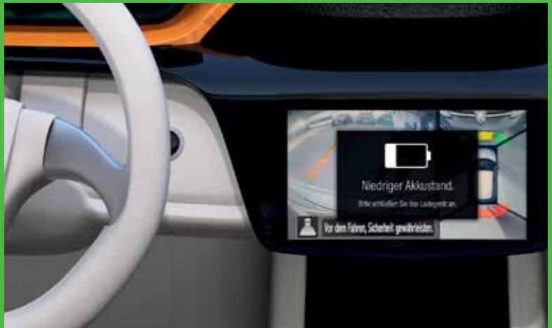
Unerwünschte Querwirkungen wie ein Hinweis zu niedrigem Akkustand während der Rückwärtsfahrt müssen ausgeschlossen werden.
