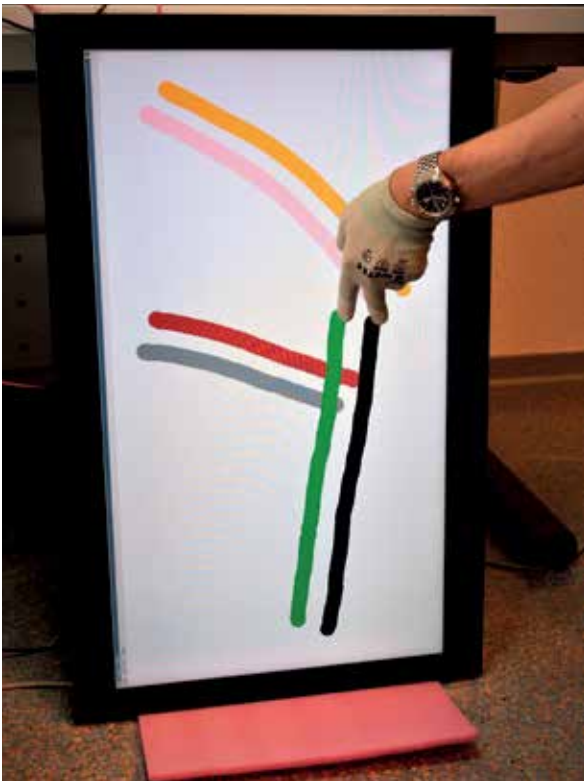
Bei der Anpassung kapazitiver Touchscreens an die Handschuhbedienung muss besonders die Sensitivität und die Störfestigkeit berücksichtigt werden.
