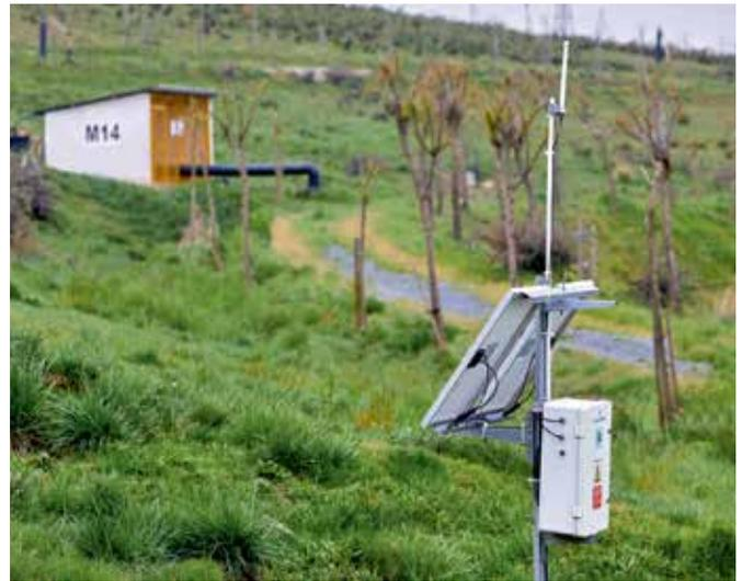
Eine der 63 Sammelstellen, die mit dem Radioline-System überwacht werden: Die Stromversorgung erfolgt über Solarpanel.
