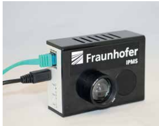
Der Li-Fi-Hotspot des Fraunhofer IPMS besitzt bei einer Distanz von 5 m eine Datenrate von 1 Gbit/s.
