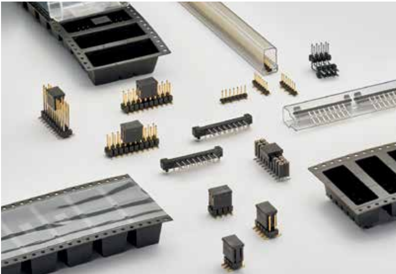
Tape & Reel oder Stangenmagazin – die Wahl der Verpackungsform für Steckverbinder hängt von den eingesetzten Herstellungsmaschinen und den Stückzahlen ab.
