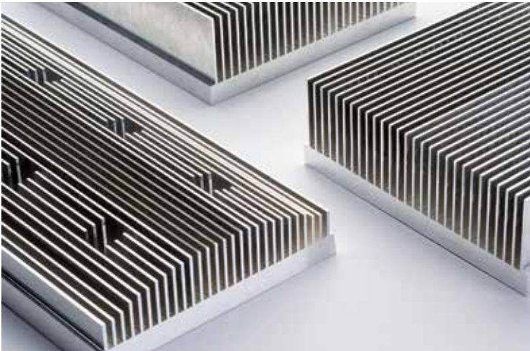
Abbildung 2: Im Strangpressverfahren nicht herstellbare engmaschige Kühlprofile können mit gewissen Restriktionen aus Vollmaterial produziert werden.
