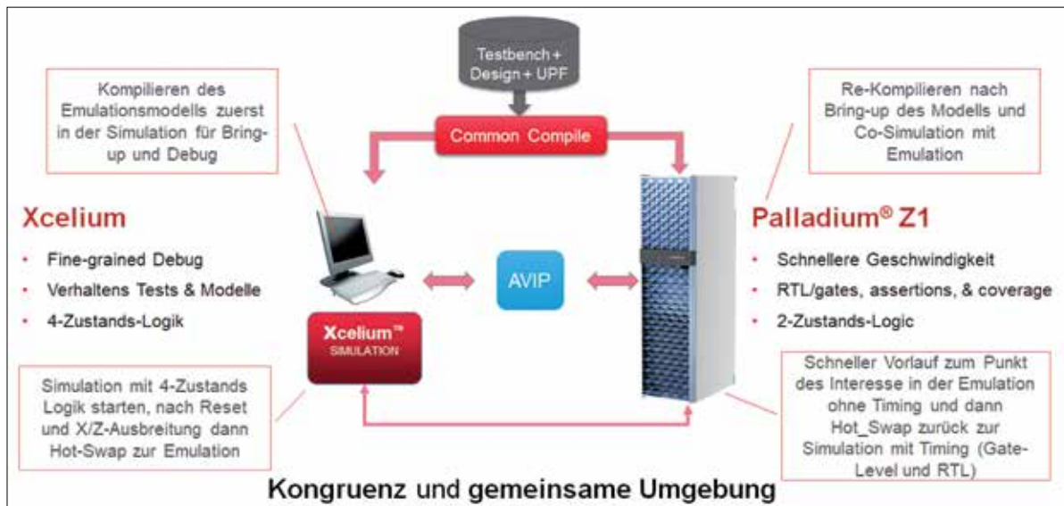
Abbildung 2: Die Kombination der zentralen Entwicklungswerkzeuge ist die Multi-Fabric-Kompilierung. Sie kann sowohl für Emulation als auch FPGA-basierte Prototypen für klassische ICE-Anwendungen benutzt werden.
