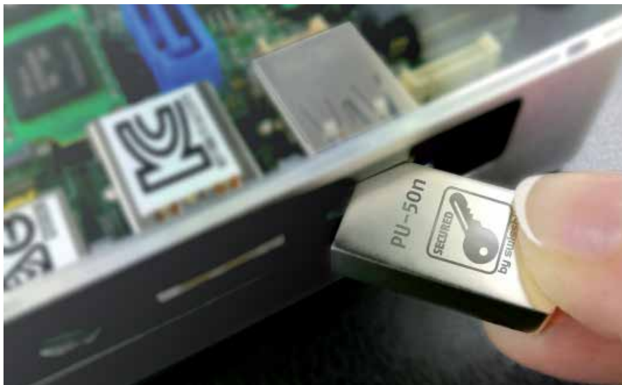
Abbildung 1: Secure Elemente lassen sich einfach über eine Standard-schnittstelle wie USB nachrüsten.
