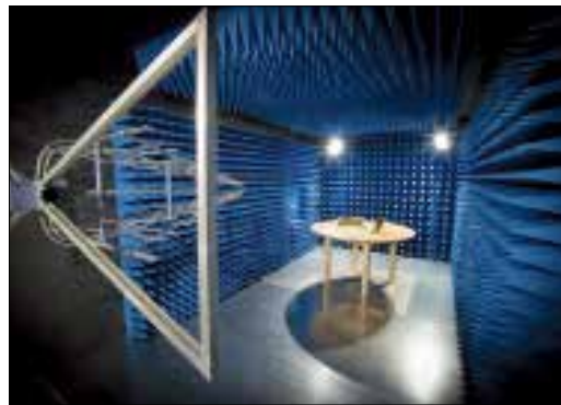
In der hauseigenen EMV-Kammer werden die Produkte auch auf EMV Konformität geprüft.
