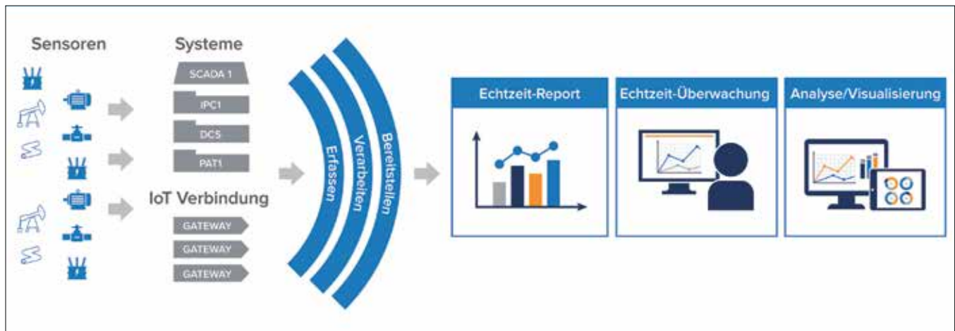
Abbildung 1: Das PI-System von Osisoft verbessert bestehende Fernüberwachungssysteme, indem es der Leitwarte technologieübergreifend die Anlagendaten in Echtzeit zur Verfügung stellt und gleich weiterverarbeitet.
