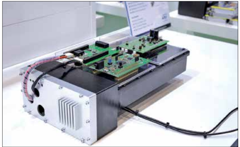
Abbildung 1: Der Demonstratoraufbau mit modular aufgebauter Stromanregung und analoger Signalaufbereitung, basiert auf dem STM32F4-Evaluations-Board.
