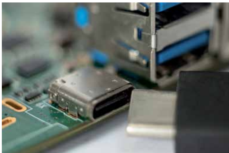
Abbildung 1: Der USB-Typ-C-Stecker ist ein platzsparender reversibler Stecker mit 24 Pins. Die Buchse ist für 10.000 Steckvorgänge spezifiziert.
