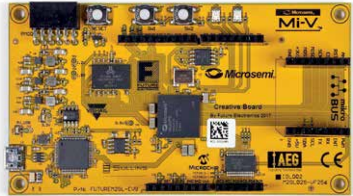
Das IGLOO2-FPGA von Microsemi unterstützt RISC-V-Cores. Dank einer integrierten IDE sind die Entwicklung und das Debugging der RISC-V-ISA sehr einfach.
